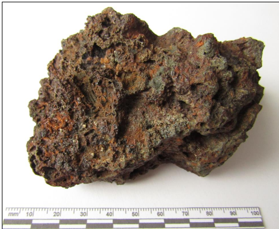
Obrázek 17: Velký vzorek strusky po zpracování železa z lokality Havírna, foto: V. Ferencová
