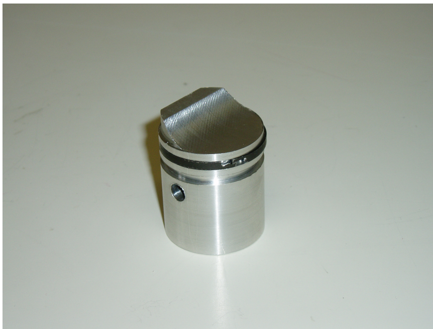
Obrázek 44: Píst s pístním kroužkem, pohled na zámek
