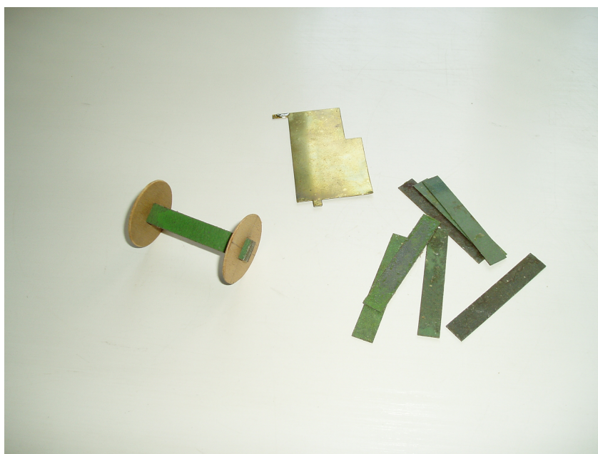
Obrázek 59: Jádrem vysokonapětové cívky
