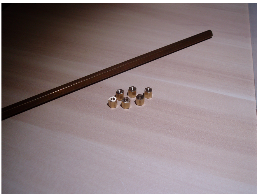
Obrázek 55: Matice na uchycení válce (dvě přebývají)
