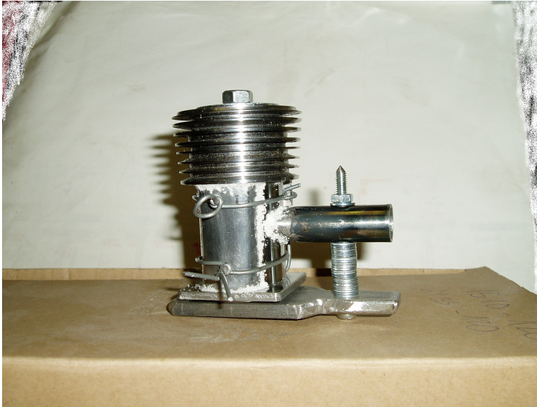
Obrázek 14: Válec před sletováním
