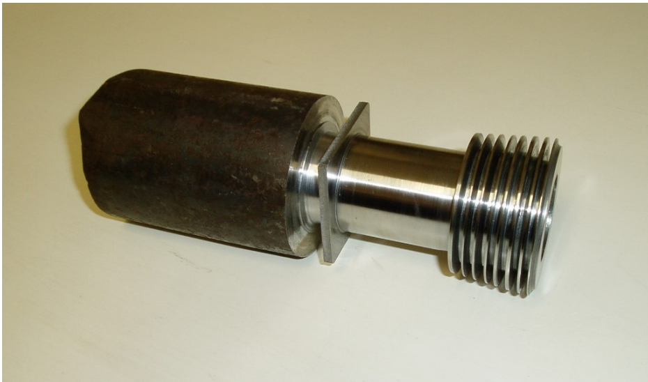
Obrázek 5: Válec s přírubou a hotovou vnější konturou
