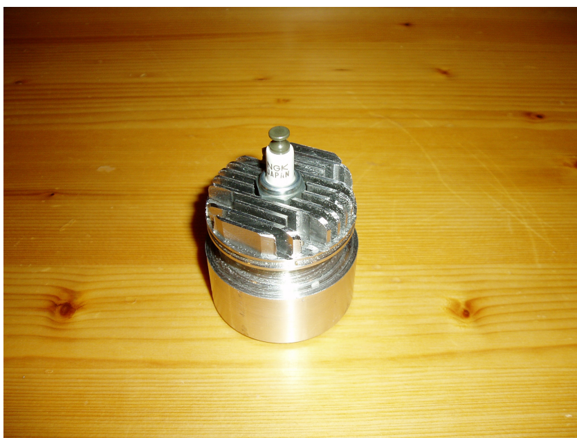
Obrázek 23: Hlava válce s vyfrézovanými žebry
