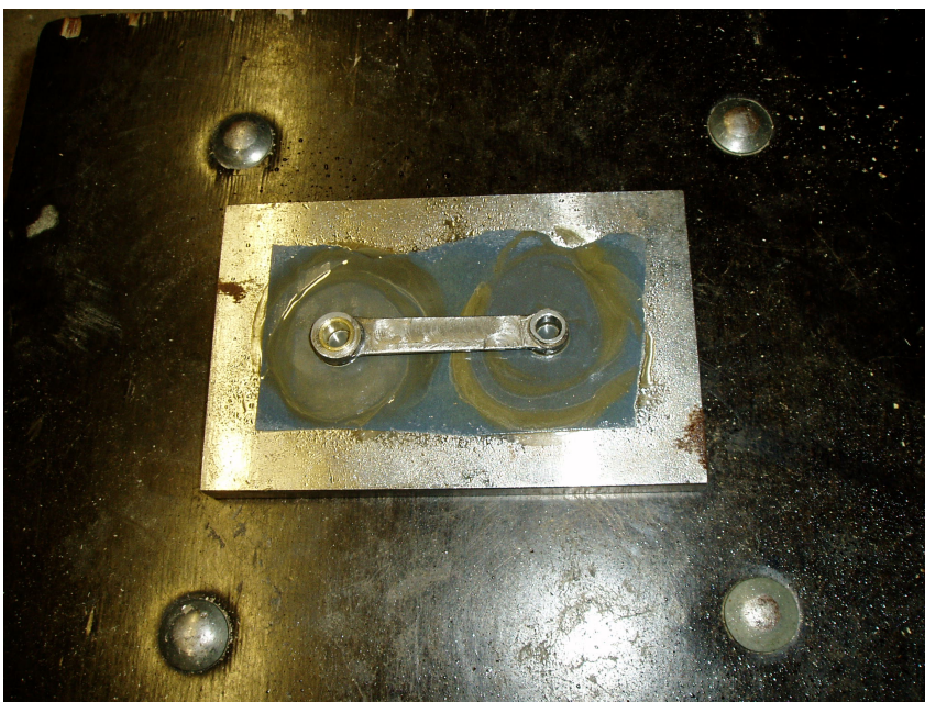
Obrázek 41: Konečné zabrušování ojnice
