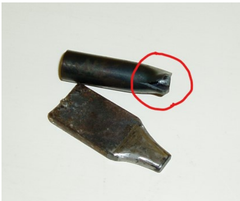
Obrázek 10: Roztržený první nátrubek
