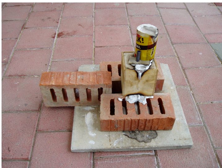
Obrázek 33: Písková forma s komínkem
