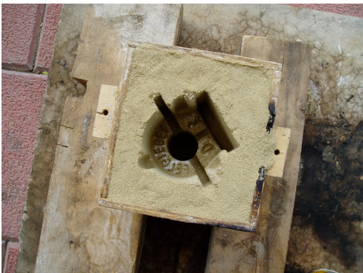
Obrázek 30: Pohled do hotové pískové formy
