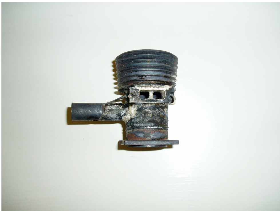
Obrázek 16: Válec po sletování
