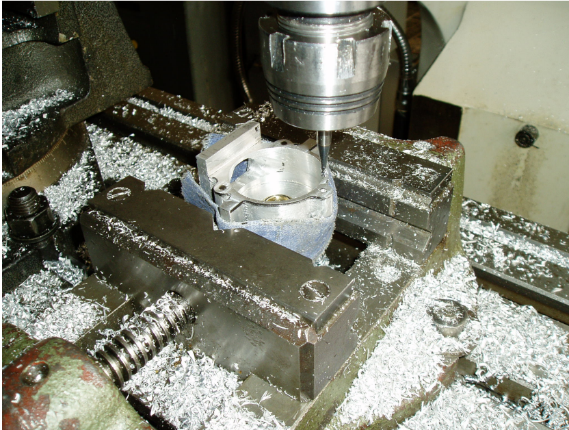
Obrázek 36: Vrtání otvorů pro připevnění zadního víka
