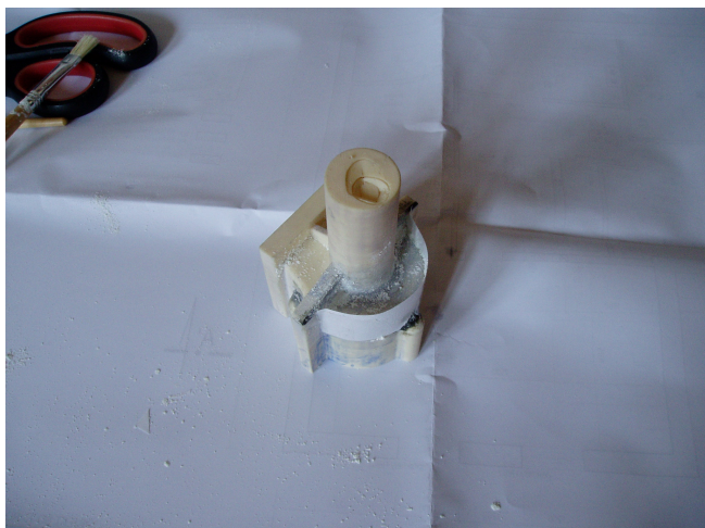
Obrázek 24: Výroba negativní voskové formy
