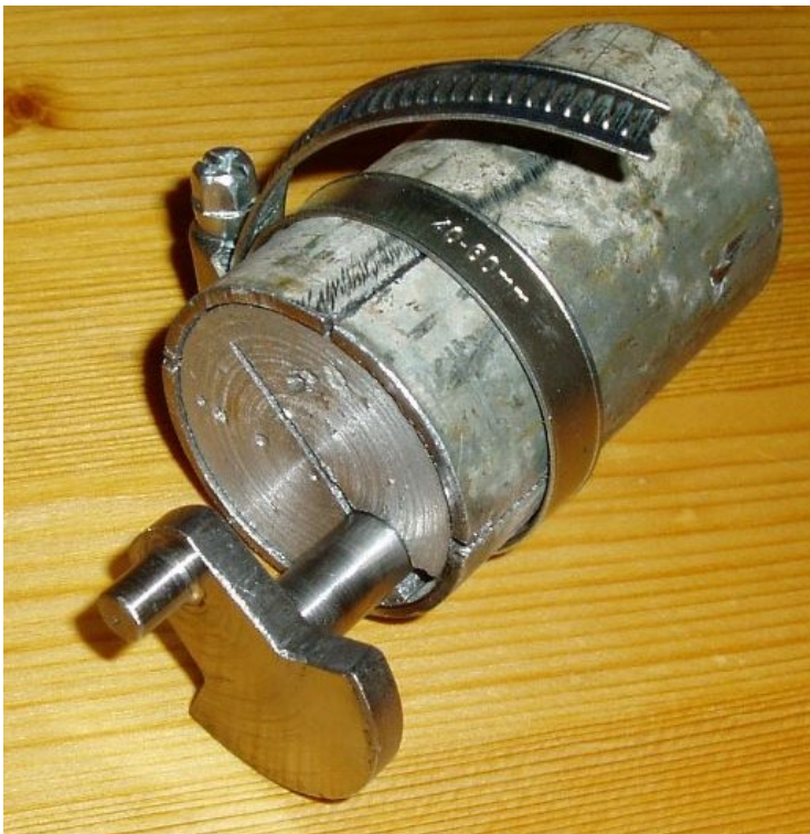
Obrázek 39: Přípravek na výrobu ojnicího čepu
