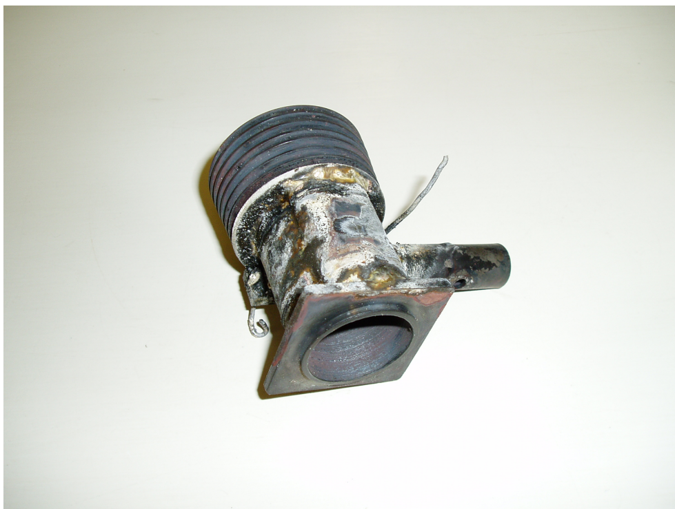
Obrázek 17: Válec po sletování
