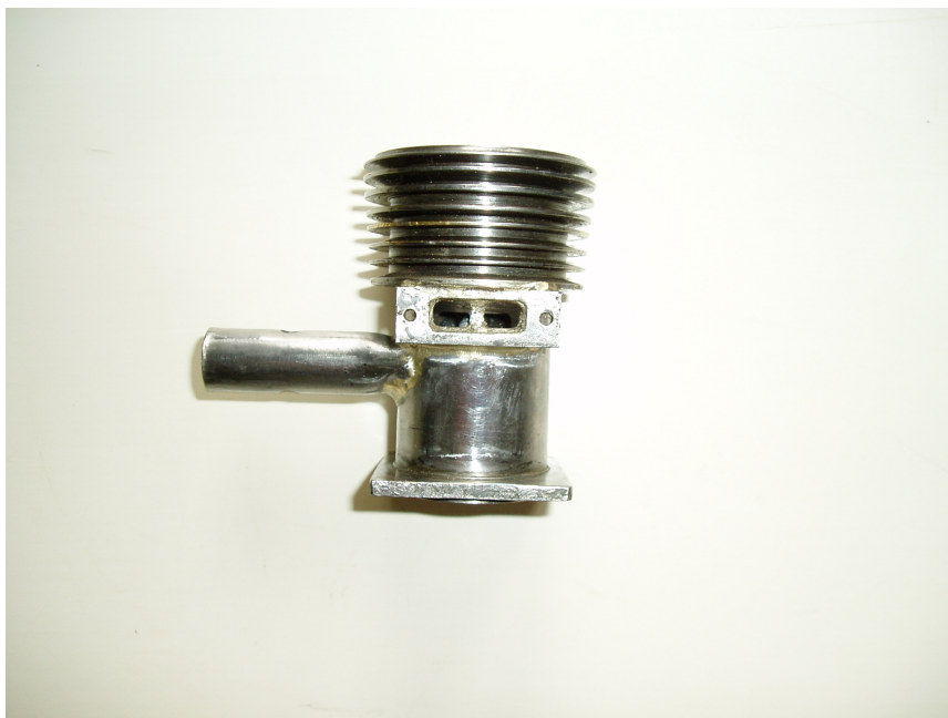
Obrázek 18: Válec po obroušení
