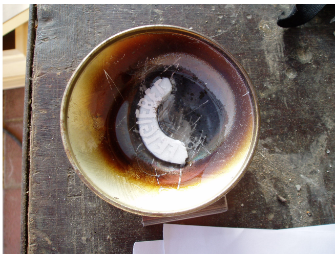
Obrázek 25: Rozpouštění negativní voskové formy
