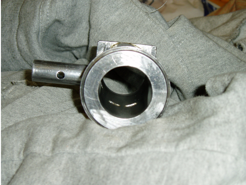
Obrázek 21: Válec po výbrusu
