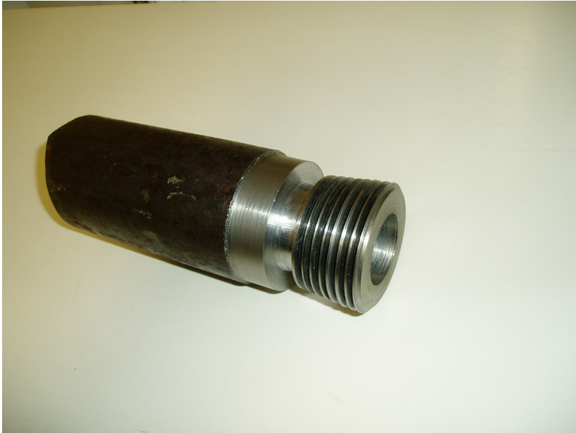
Obrázek 4: Válec s vysoustruženými žebry
