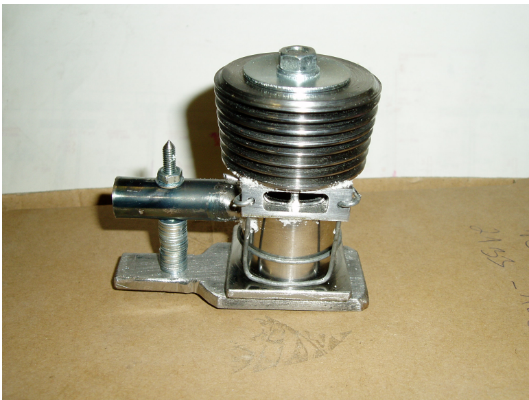
Obrázek 15: Válec před sletováním, pohled na výfuk
