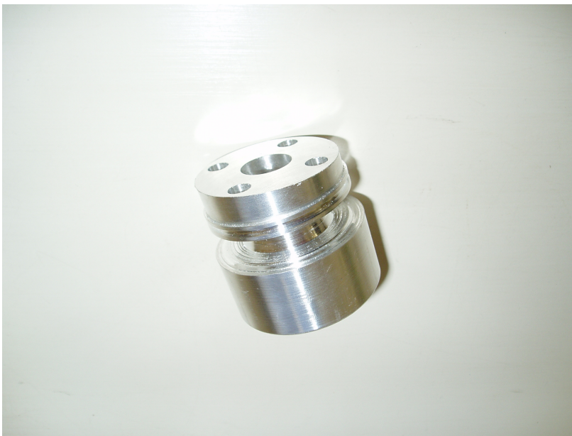
Obrázek 22: Soustružená hlava válce
