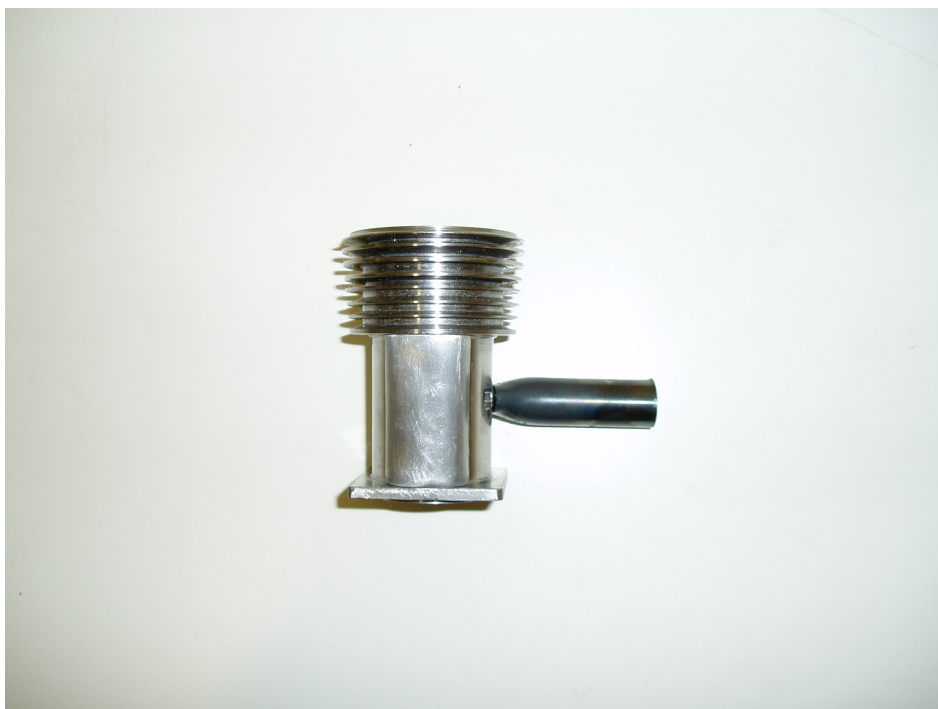
Obrázek 13: Nátrubek a přepouštěcí kanál na válci
