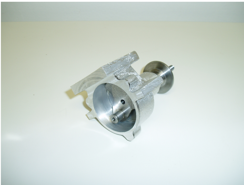
Obrázek 37: Obrobená kliková skříň s klikovým hřídelem a vrtulovým unašečem
