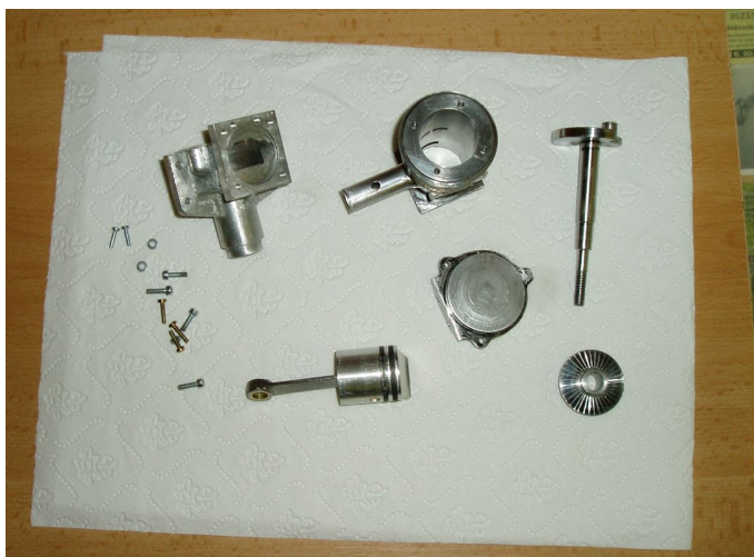
Obrázek 56: Základní součásti motoru (bez hlavy válce)
