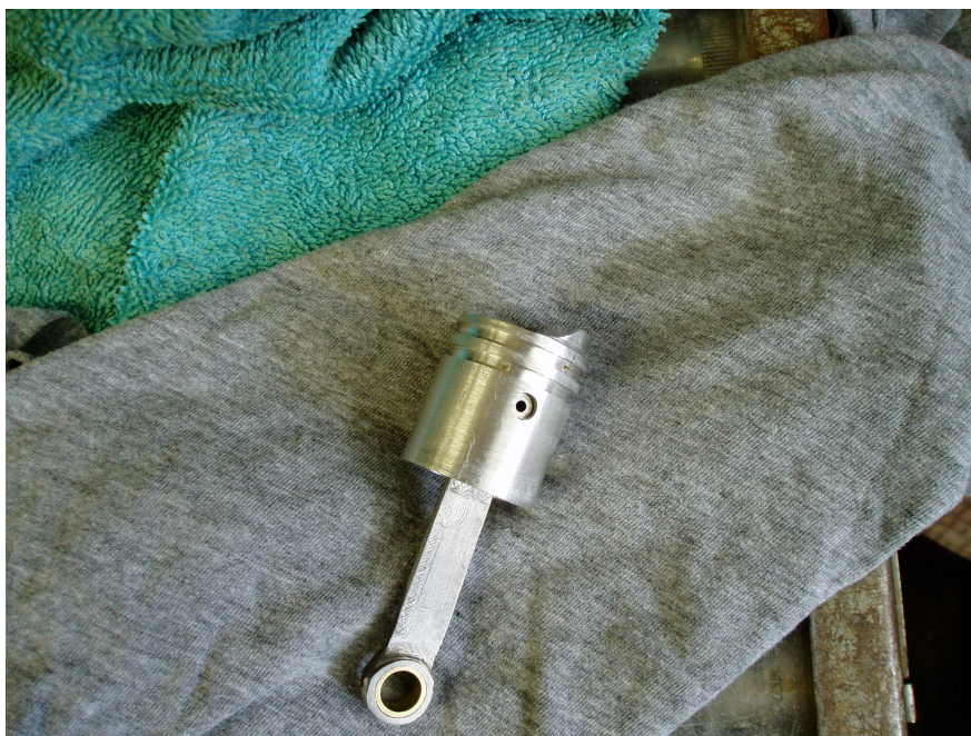
Obrázek 52: Detail na zámky pístních kroužků
