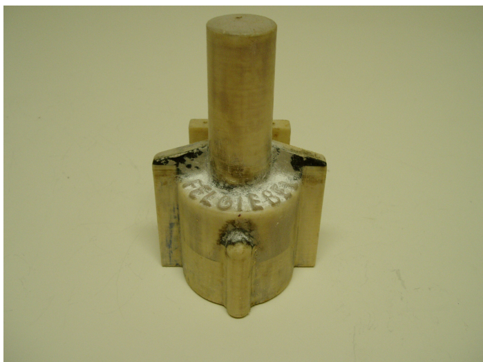
Obrázek 27: Hotový pozitivní model
