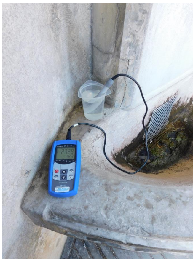
Obrázek 7: Měření konduktivity minerální vody z Kropáčova pramene. Foto Hana Koryčánková.
