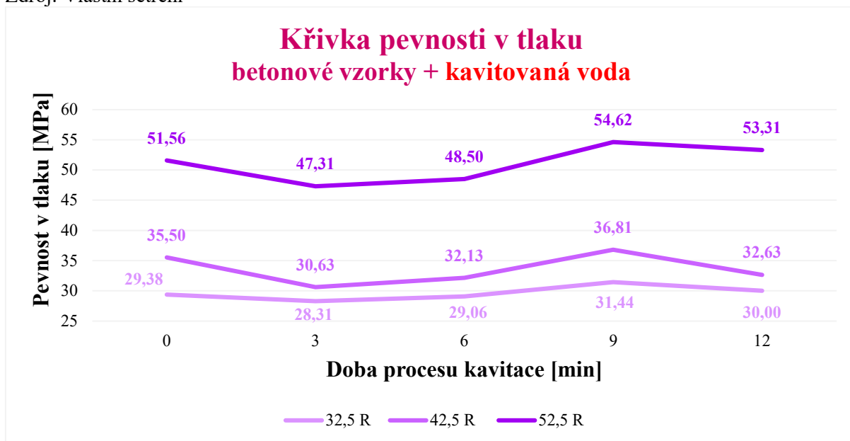
Graf 38: Pevnost v tlaku betonových vzorků s kavitovanou vodou
