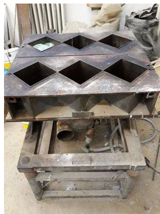
Vibrolis na pomoc při míchání vzorků a zhuťování směsí.
