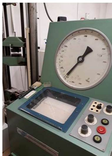
Zkušební lis na stanovení pevnosti vzorků v tlaku.
