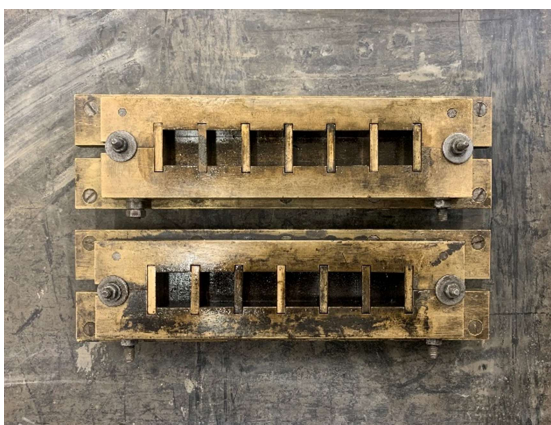
Formy na výrobu zkušebních 6ti zkušebních vzorků o rozměru a = 20 \times 20 \times 20 mm.
