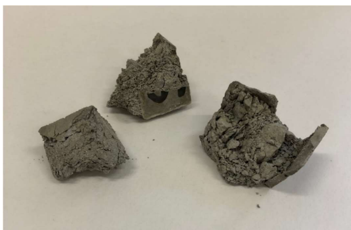
Obr. 3: Destrukce vzorků ze směsi CEM 32,5 R, voda a plastifikátor Murasan BWA 14 (6 g)
