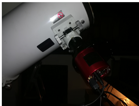
Obrázek 2.3: CMOS kamera použita k mému pozorování. Jedná se o kameru ASI1600MM Pro.
