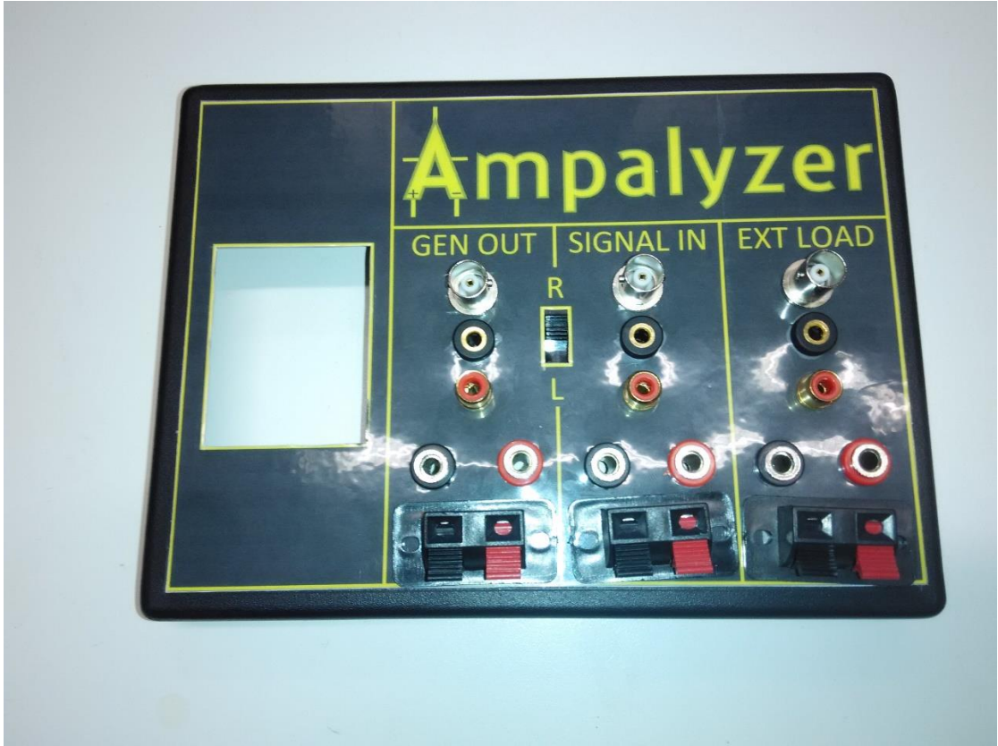
Příloha 7.3C – Přilepení potisku a osazení konektory
