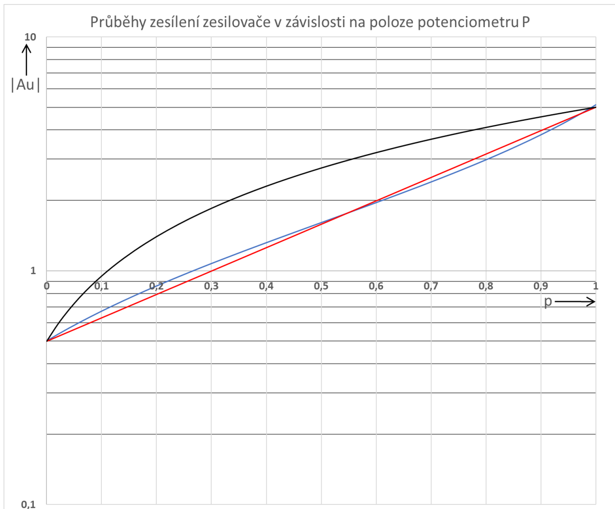
Obr. 7– Graf průběhů zesílení zesilovače v závislosti na poloze potenciometru P
