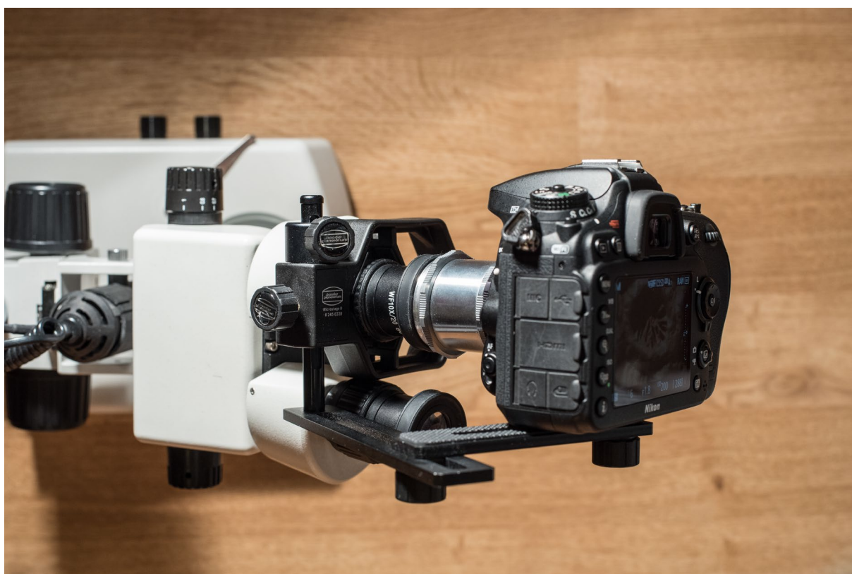
Obrázek 6– uchycení fotoaparátu k mikroskopu (foto archiv autora)
