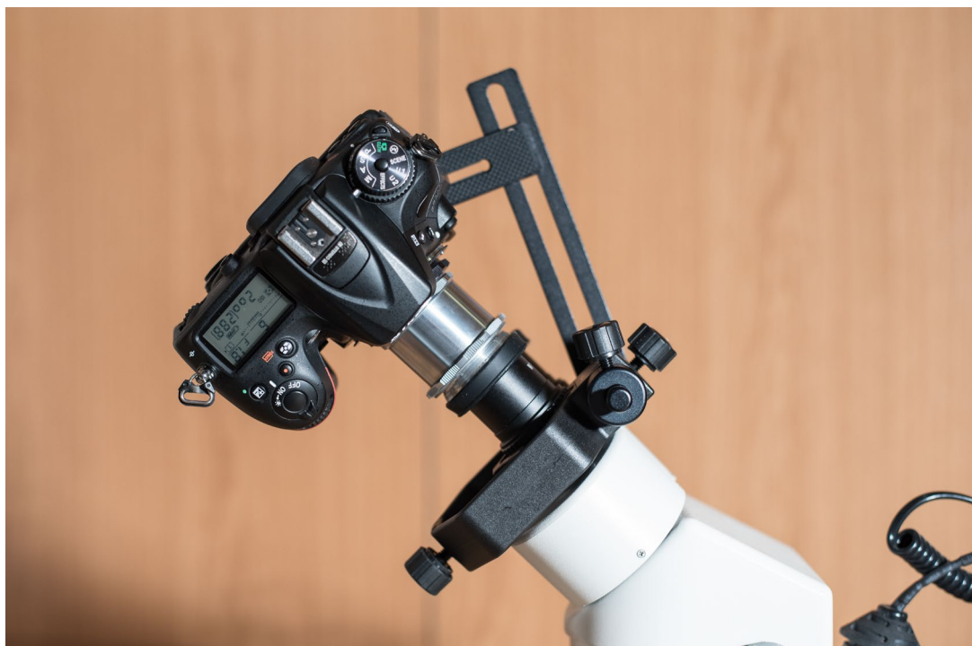
Obrázek 5 – uchycení fotoaparátu k mikroskopu (foto archiv autora)
