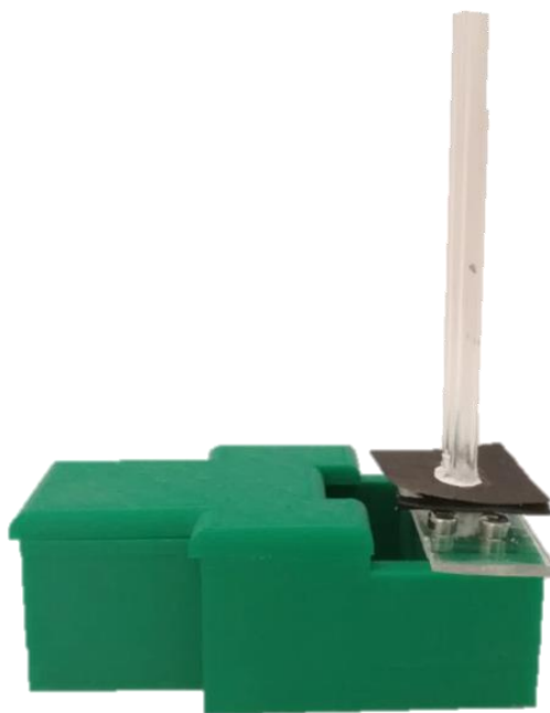
Obr. 49 Trubičky pro měření průtoku a maximálního přípustného diferenciálního tlaku.
