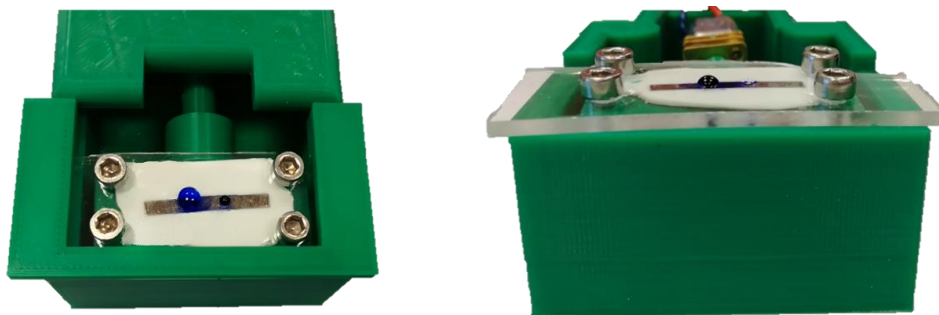
Obr. 38 Pohled na aktivní element shora a z boku při pumpování kapky inkoustu.
