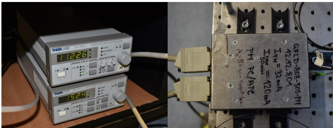
Obrázek 23: Zdroj laseru a jeho regulátor teploty vidíme vlevo. Vpravo je pak vlastní emitující laserová dioda.
