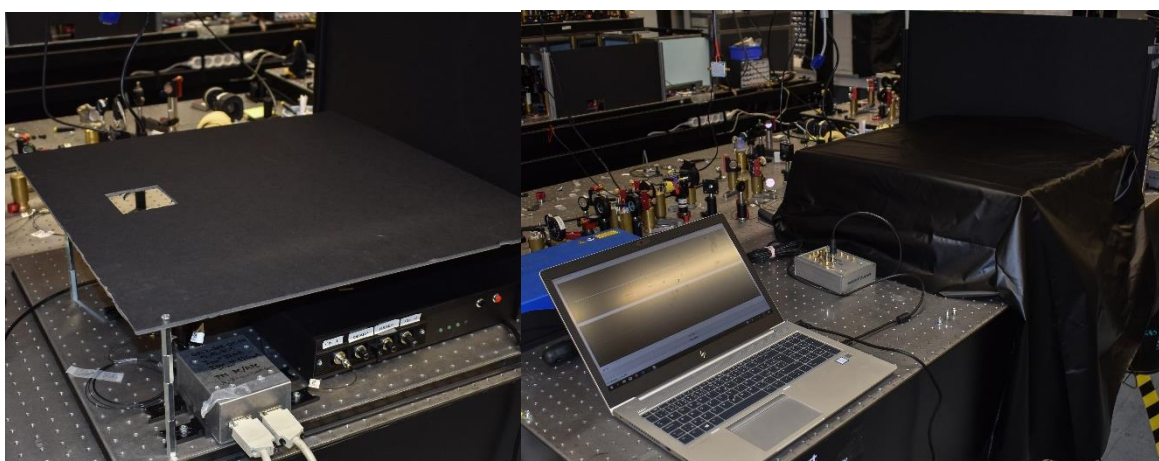
Obrázek 34: Celá aparatura překrytá černou deskou a plachtou, aby se redukovalo množství okolního světla v laboratoři. Vlevo vidíme vyřezaný otvor pro vkládání vzorku.
