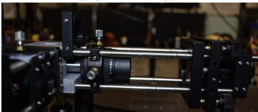
Obrázek 32: Prvky aparatury, kterými projde laser před vstupem do vzorku. Zprava jde o kolimátor, ND-filtr, půlvlnnou destičku a spojnou čočku.
