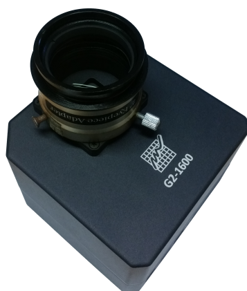
Obrázek 3: Kamera G2-1600 od firmy Moravské přístroje s nasazeným komakorektorem. Fotografie vlastní, pořízena při provádění údržby na dalekohledu VSEST.
