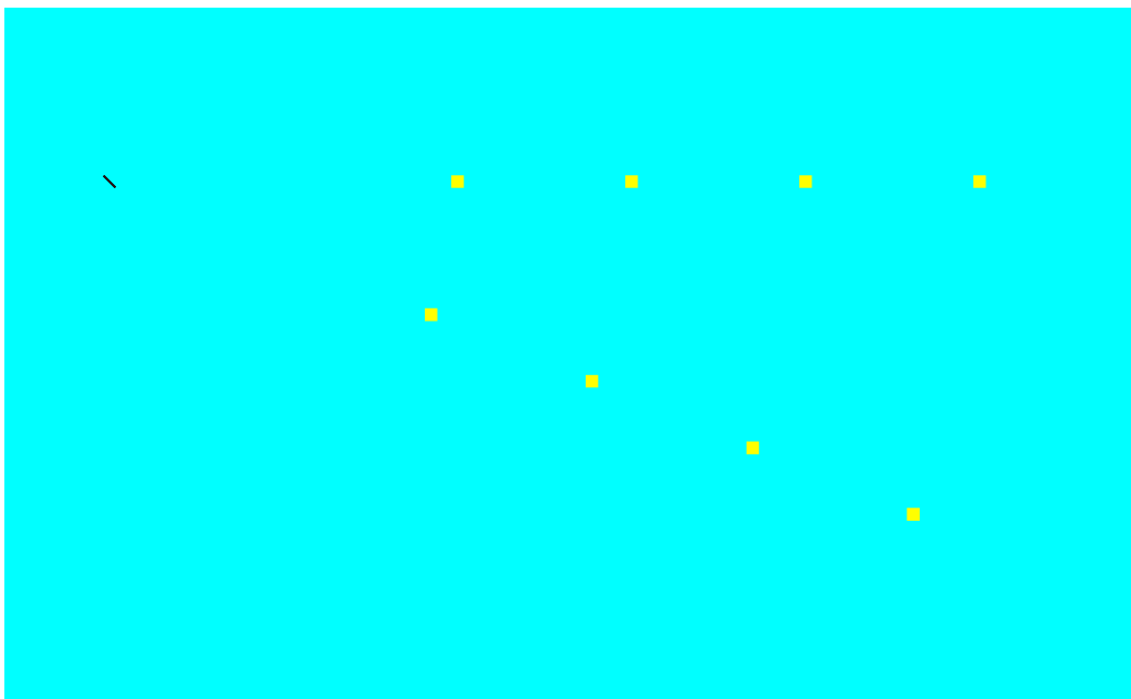
Obrázek 12: Geometrie použitá při simulaci meteoru v dispersním prostředí. Detektory byly umístěny do vzdáleností postupně 20 km, 30 km, 40 km a 50 km od středu meteoru.
