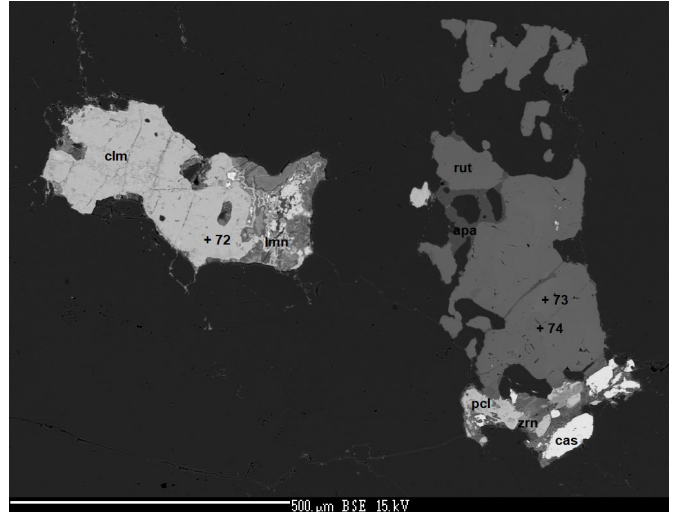
Obr. 30: Columbit-(Mn) a další minerály v BSE, bloková jednotka. Foto: operátor mikrosondy.
