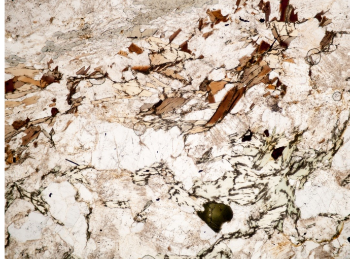
Obr. 14: Biotit (hnědá) částečně alterovaný na chlorit (nazelenalá), kontaktní zóna. FOV 2 mm. Foto: autor.
