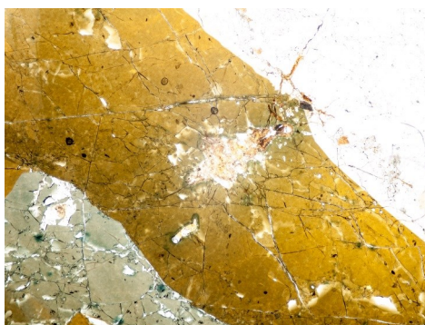
Obr. 24, 25 a 26: Zirkon uzavřený v zonálním turmalínu s drobnými inkluzemi uraninitu v BSE (vlevo), polarizovaném světle (vpravo) a ve viditelném světle (uprostřed), bloková jednotka. Foto: operátor mikrosondy a autor.
