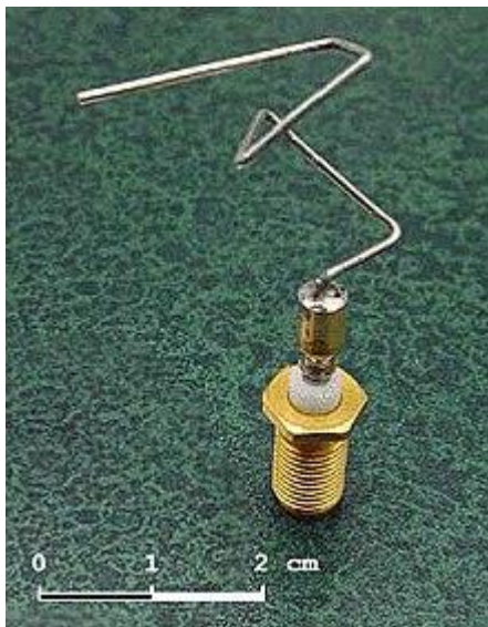
Obrázek 7 Anténa vyvinutá pro misi NASA [19]
