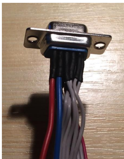
Pájení vodičů k VGA konektoru
