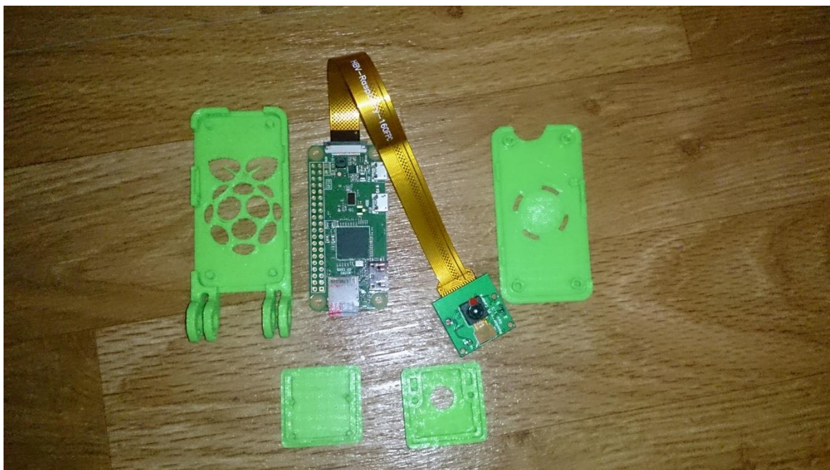
Příloha 9: Vytisknutý kryt pro řídicí mikro počítač Raspberry Pi Zero W s kamerou
