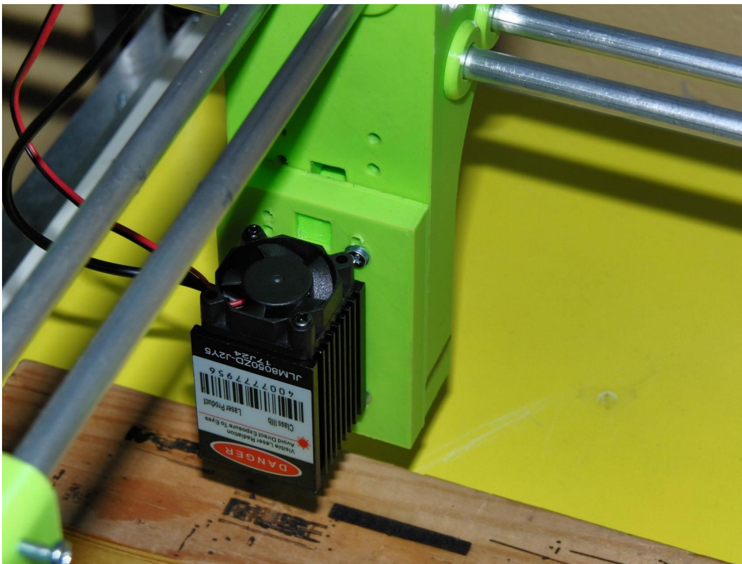
Příloha 4: Hlava tiskárny osazená laserovým modulem s příklady gravírování
