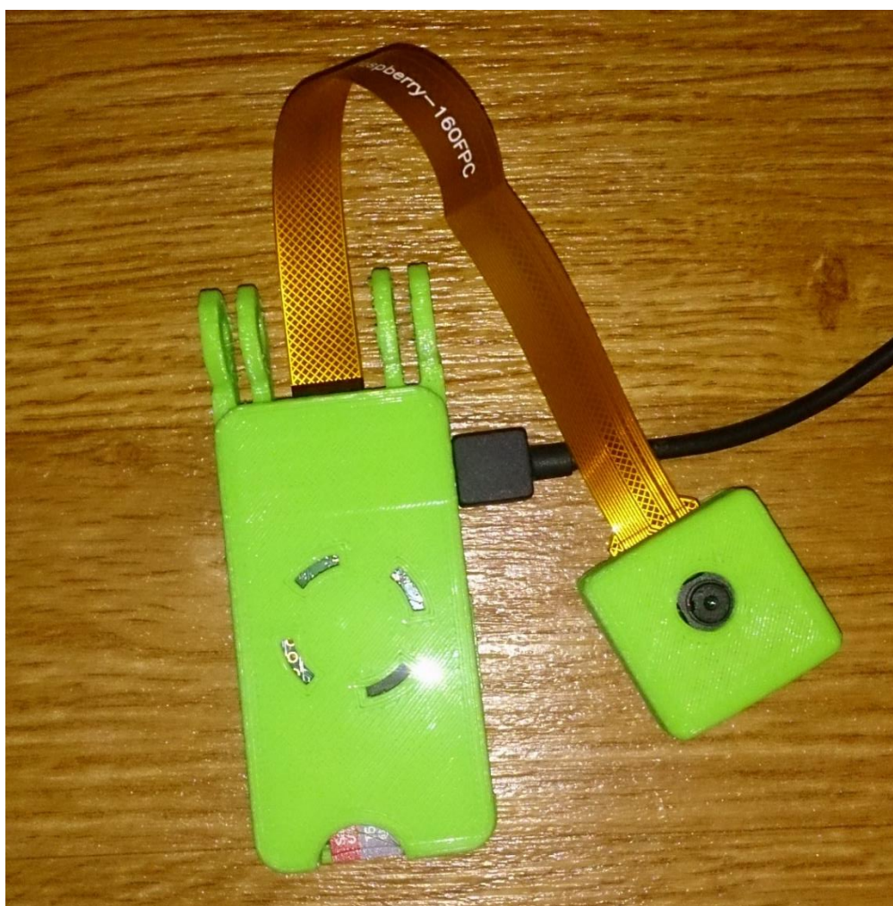
Příloha 10: Setavený kryt pro mikro počítač Raspberry Pi Zero W s kamerou
