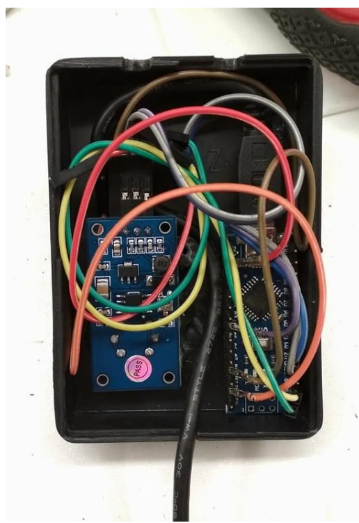
Obr. 5 Zapojení Arduina Nano a modulu MQ-135
