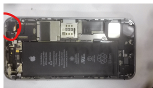
(c) Umístění kamerového modulu v demontovaném telefonu.
