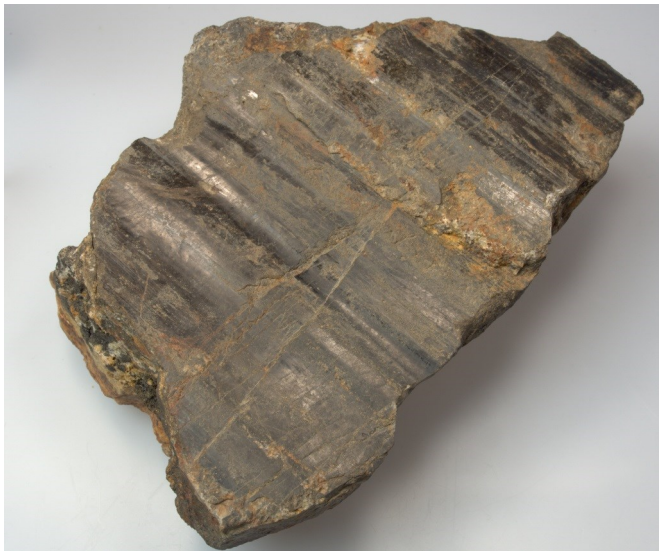
Obr. 13: Turmalínové tektonické zrcadlo ze smykové zóny, 20 cm. Foto JV.
