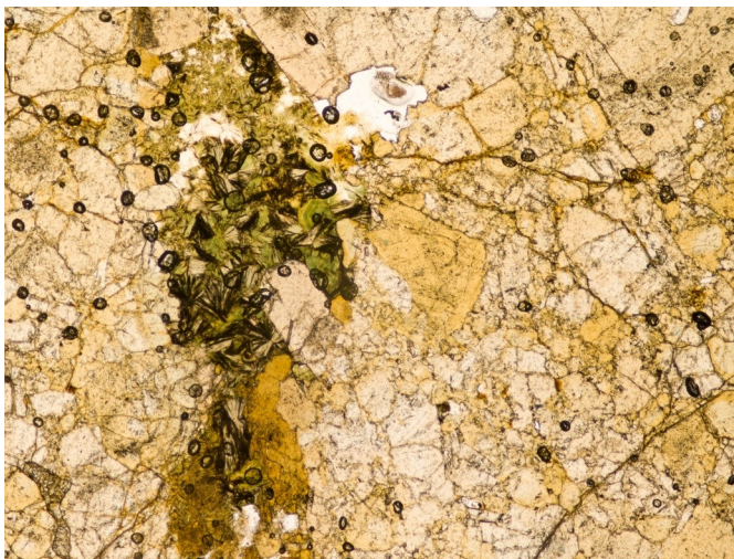
Obr. 28 a 29: Turmalín alterovaný chloritem (vějíře) přeměněným na biotit. Vlevo ve viditelném světle, vpravo v BSE. Foto JV.
