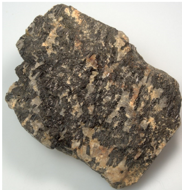
Obr. 2: Minerální lineace turmalínu na pegmatitu č. 8, 22 cm. Nález dokazuje pohyb během krystalizační fáze pro primární turmalín. Foto JV.
