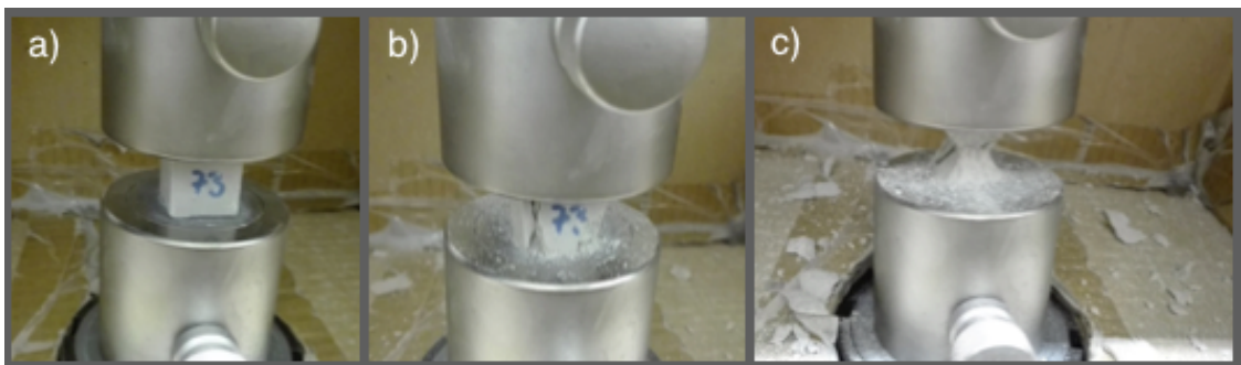
Obrázek 14. Geopolymerní vzorek před (a), v průběhu (b) a po (c) zkoušce pevnosti v tlaku.
