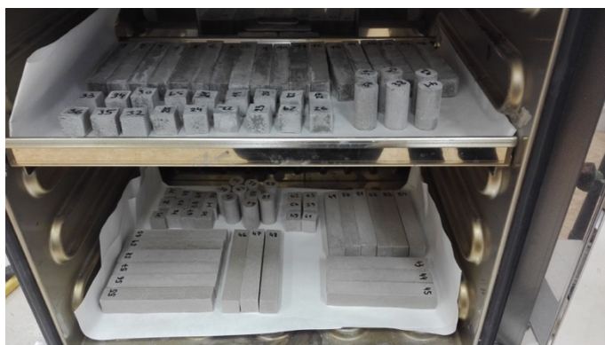
Obrázek 11. Vzorky betonu a geopolymery v laboratorní sušárně.
