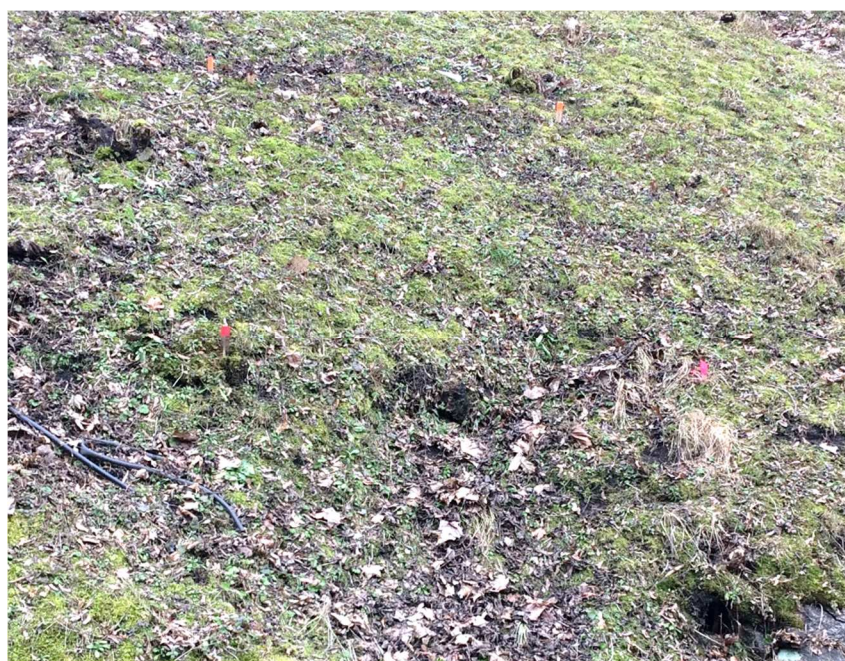
Obr. 4 Signalizace identických bodů dřevěnými kolíky a reflexním sprejem
