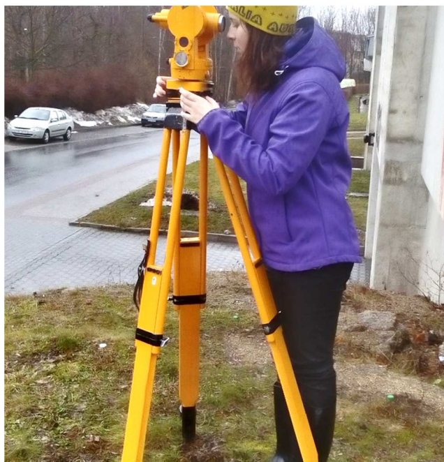
Obr. 8 Příprava teodolitu Dahlta 010A k měření kontrolních bodů
