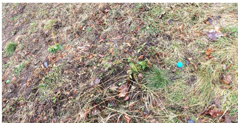
Obr. 3 Signalizace identických bodů plastovými víčky
