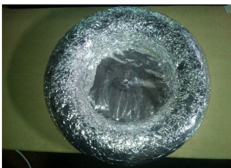
Obrázek 4.7: První pokus o toroid, polystyrenový věnec obalený alobalem.
