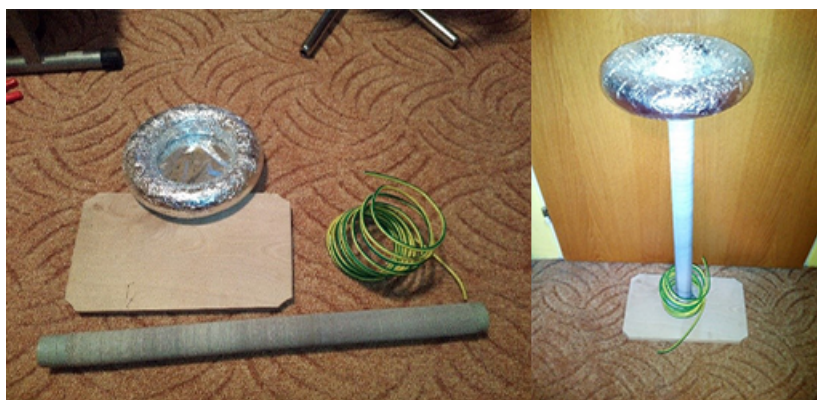
Obrázek 4.9: První pokus o Teslův transformátor rozložený (vlevo) a složený (vpravo).
