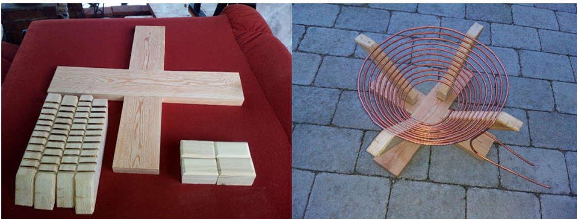
Obrázek 4.14: Stavba kuželové cívky (vlevo), hotová kuželová cívka (vpravo).
