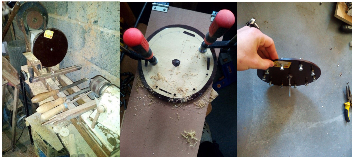
Obrázek 4.30: Kolo upnuté v soustruhu (vpravo), vrtání děr (ve středu), hotové kolo na první testy (vpravo).
