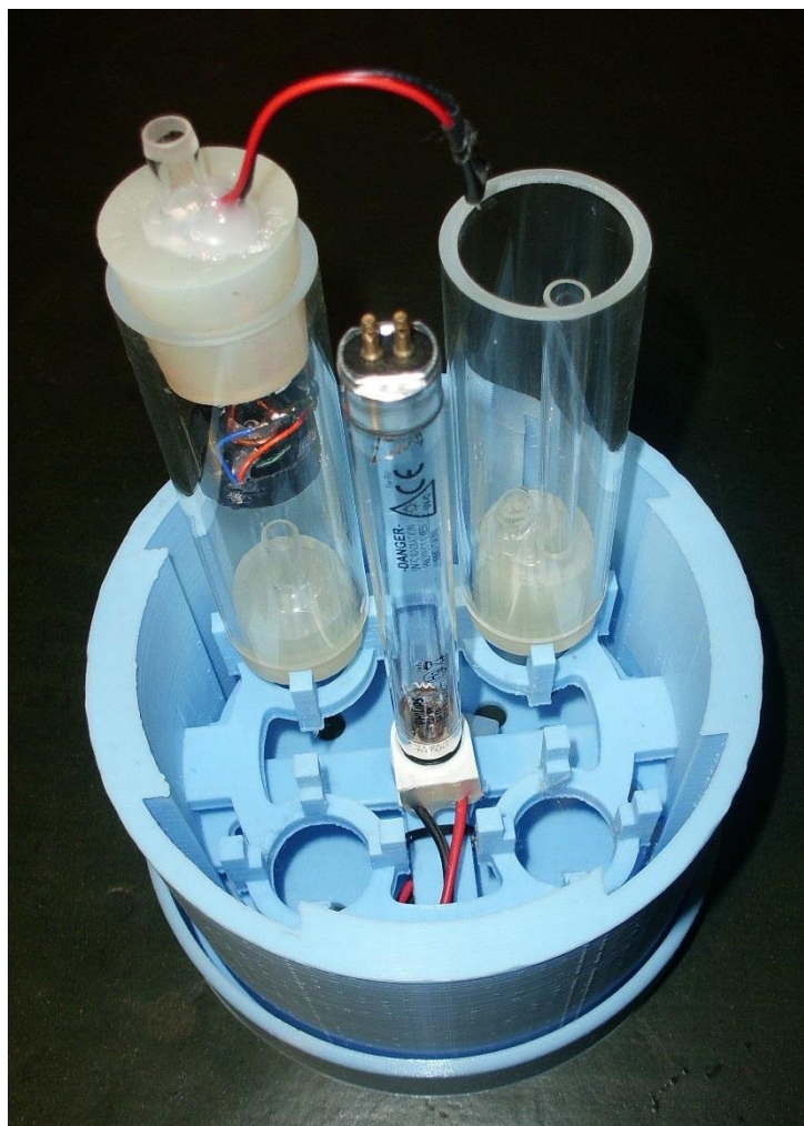
Obr. 19: Ukázka uchycení křemenných trubic v konstrukci z 3D tiskárny. Konstrukce se konkrétně skládá z pěti samostatně vytisknutých dílů.
