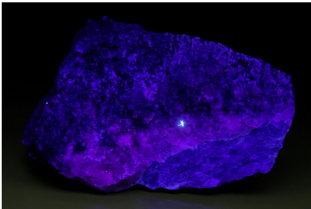
Obr. 69: Scheelit, zrno 3 mm v UV světle. Foto: T. Kadlec.
