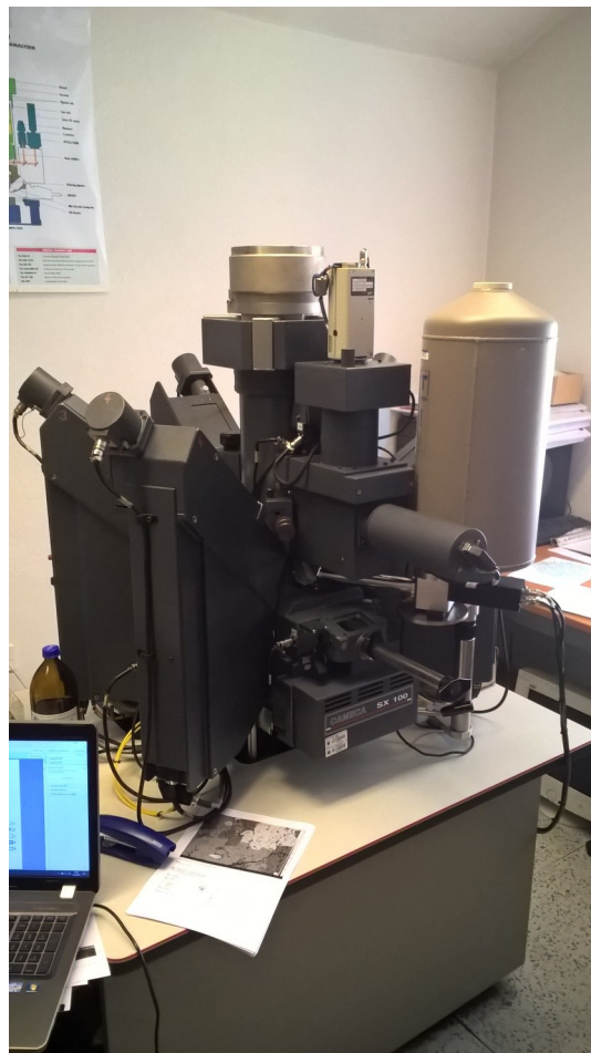
Obr. 10: Elektronová mikrosonda CAMECA SX 100.
