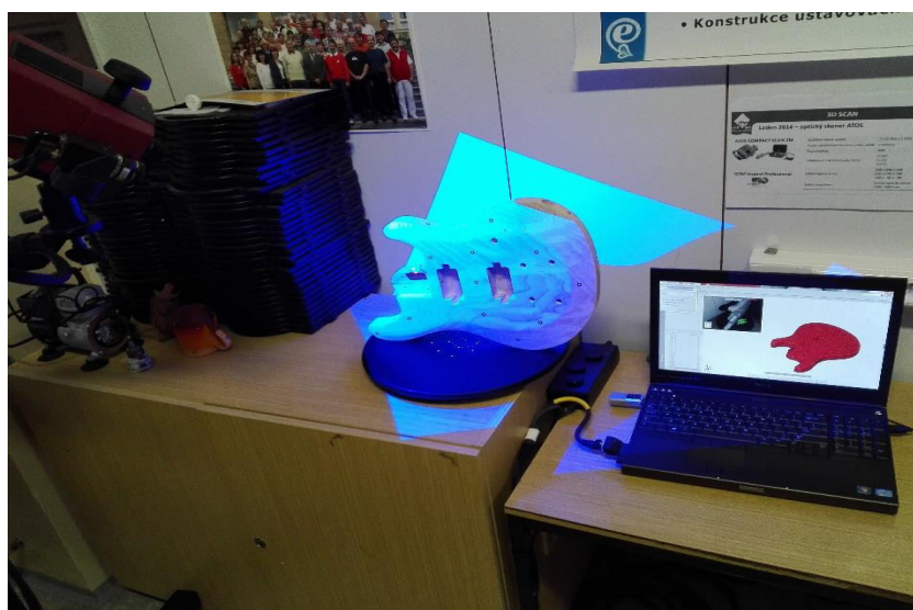
Obrázek 42 - Skenování těla nástroje pomocí ATOS-COMPACT 3D SCAN 2M
