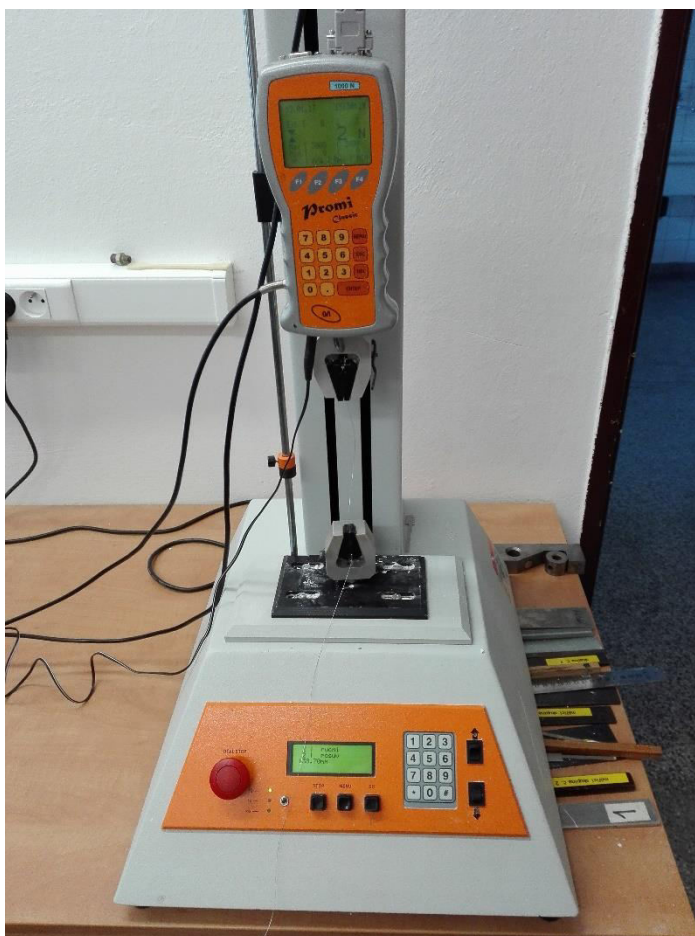
Obrázek 33 - Trhací zařízení s upnutou strunou
