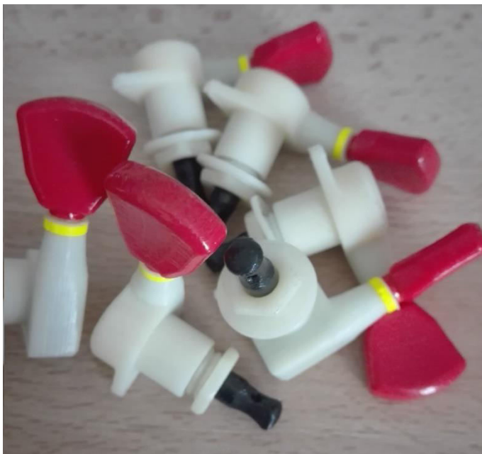
Obrázek 26 - Vytisknutá ladící mechanika pomocí 3D tiskárny
