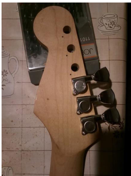
Obrázek 57 - Přišroubování ladící mechaniky
