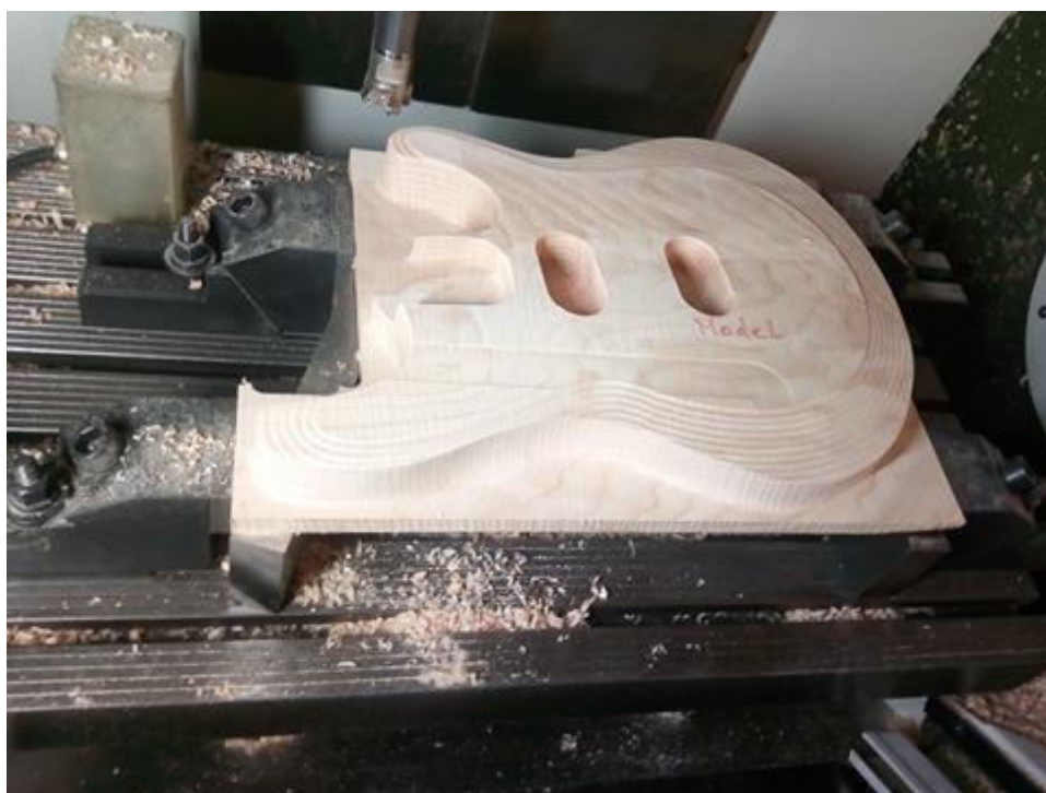
Obrázek 39 - Výroba těla nástroje na CNC frézce
