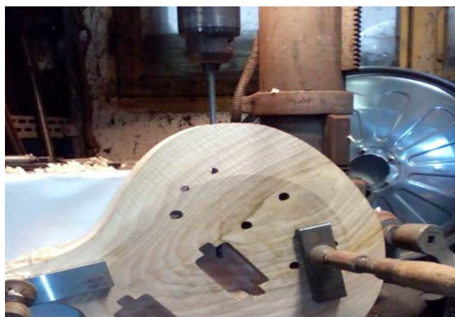
Obrázek 40 - Vrtání otvoru pro umístění kabeláže
