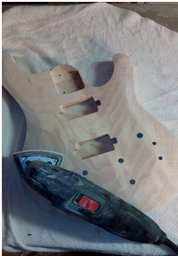
Obrázek 46 - Broušení těla nástroje vibrační bruskou
