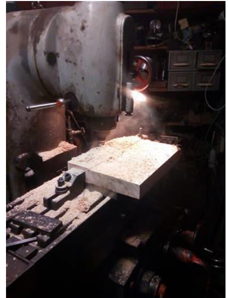
Obrázek 6 - Opracování materiálu na polotovár
