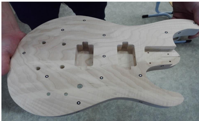
Obrázek 41 - Tělo nástroje polepené referenčními body
