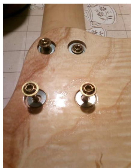
Obrázek 55 - Spojení krku kytary s tělem nástroje
