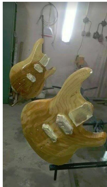
Obrázek 50 - Sušení těl nástrojů po lakování
