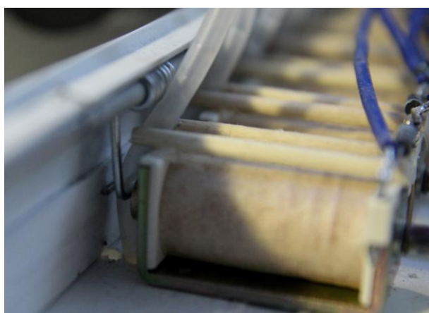
Obr. 5: Vyrobené ventily stlačující hadičku mezi dráty
