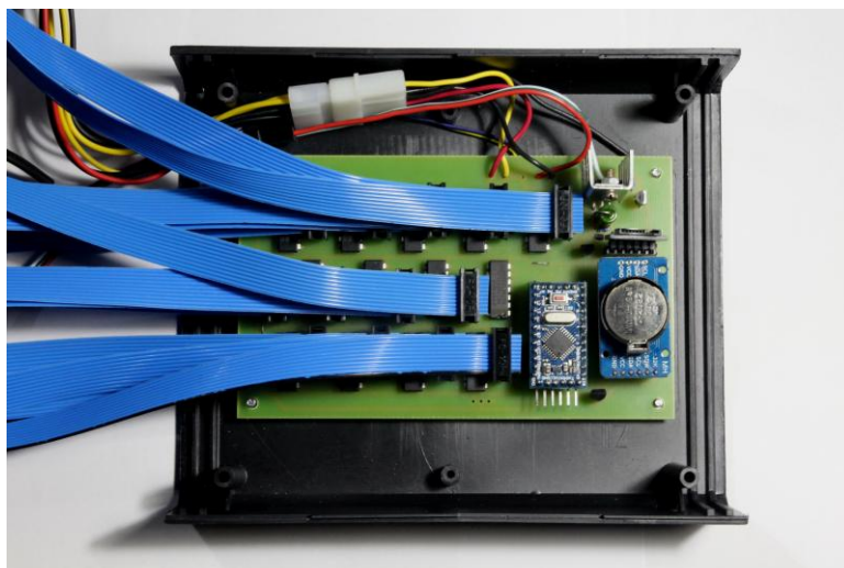
Obr. 20: Osazený plošný spoj umístěný do krabičky
