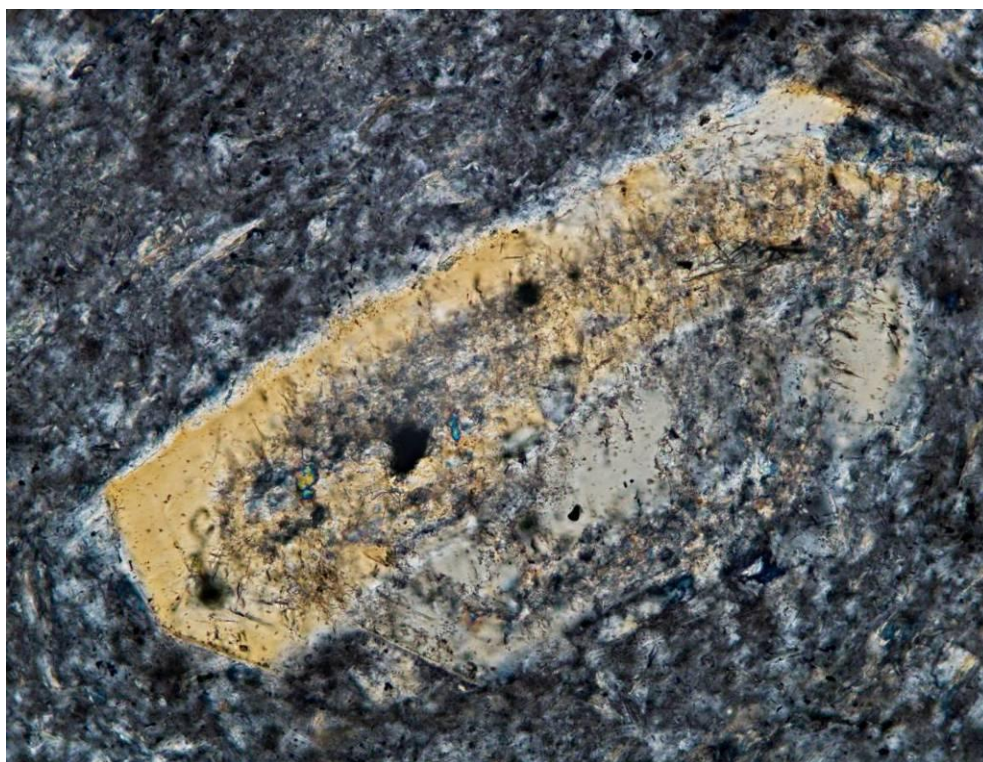
Obr. 114 Kaolinizace mění strukturu a stavbu vyrostlice živce. Vzorek B při zvětšení 200x a světla xpl. (BnČ)
