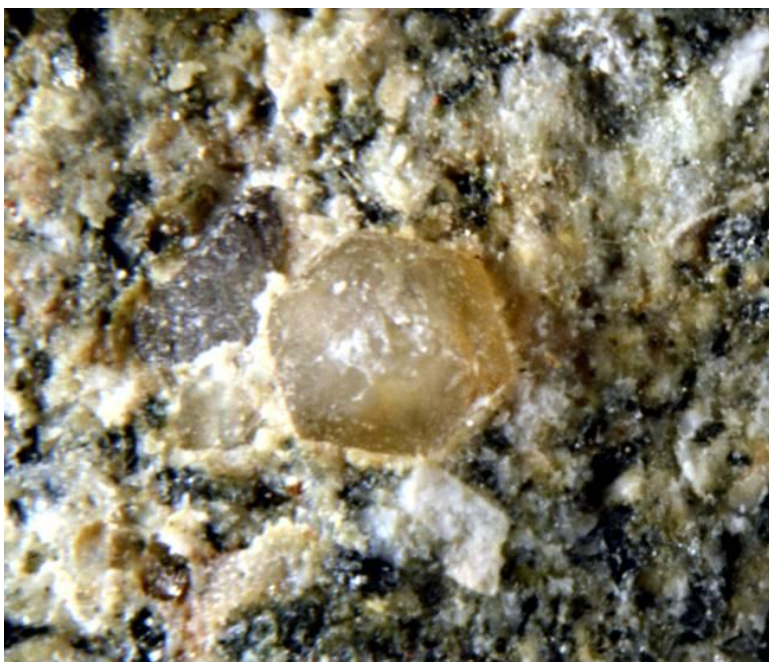
Obr. 92 Hexagonální křemen ve vzorku 09, nachází se v hrubozrnném porfyru a je velmi pravidelný, takže měl dostatečnou teplotu, podmínky a čas na krystalizaci (makrofotografie, BnČ).
