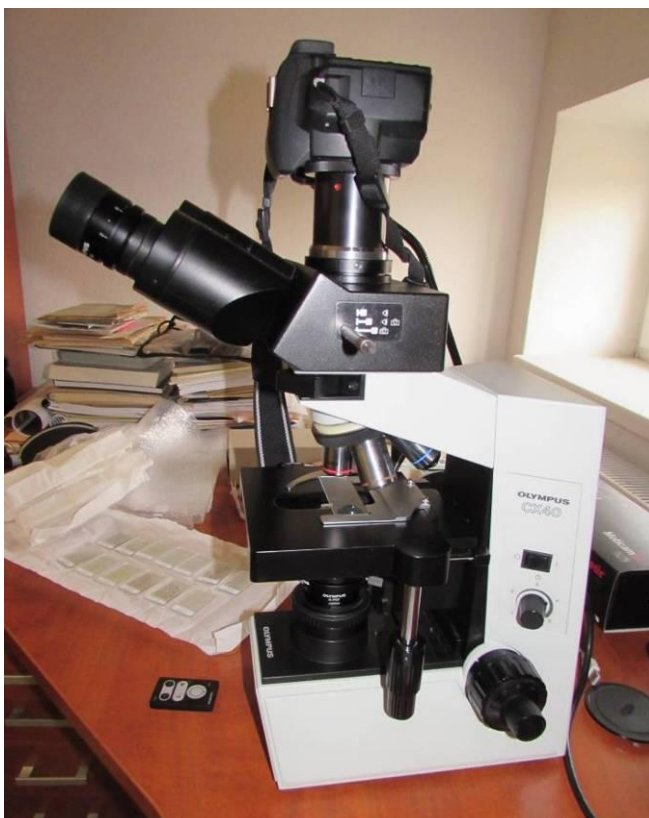
Obr. 44 Olympus CX40, biologický mikroskop v Jihočeském muzeu s nástavcem na fotoaparát, zrcadlovka Olympus E-500 s dálkovým infračerveným ovládáním (dole před mikroskopem).
