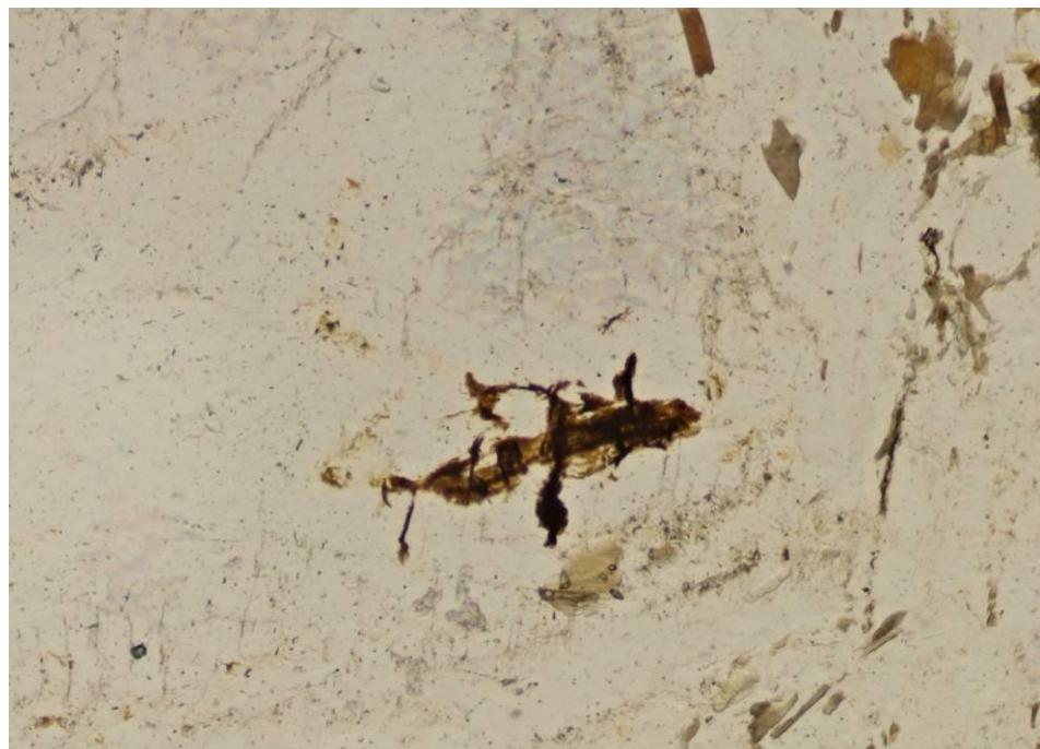
Obr. 105 Ortoklas obsahuje průniky železitanů uvnitř své struktury. Vzorek H5 při zvětšení 100x a světle ppl. (Hf)
