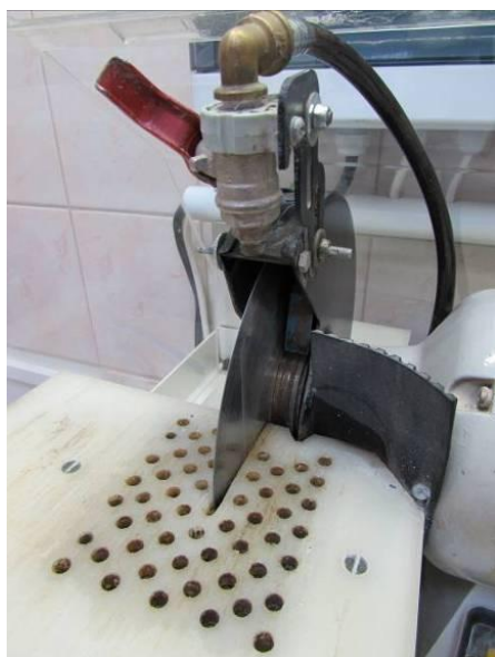
Obr. 28 Nařezání výbrusových kostek (3 x 2,2 cm) z geologického materiálu, které se po zabroušení budou lepit na podložní sklíčka
