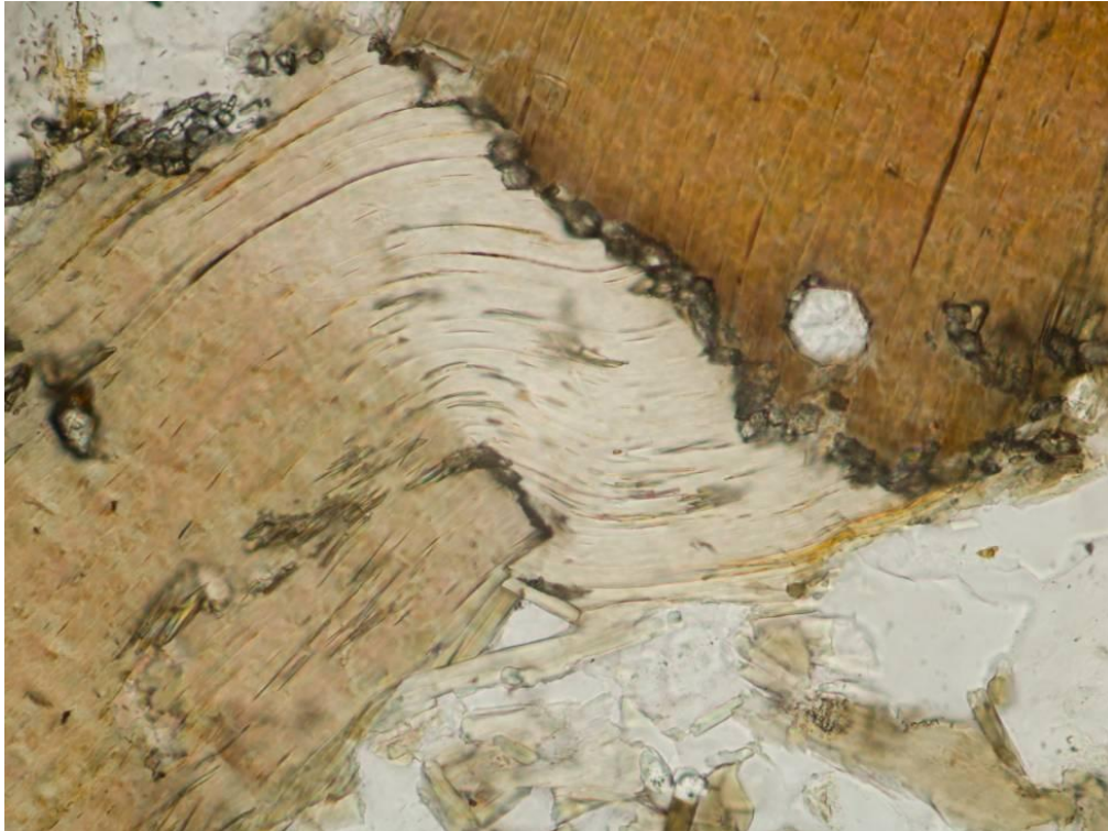
Obr. 118 Detail deformace biotitu z předchozí fotografie. Vzorek H6 při zvětšení 400x a světle ppl. (Hf)
