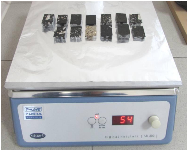
Obr. 31 Vybrúšené kostky se nahřejí na temperované plotýnce při teplotě 50 – 60°C, teplota nesmí být příliš vysoká, aby nedošlo k poškození minerálů
