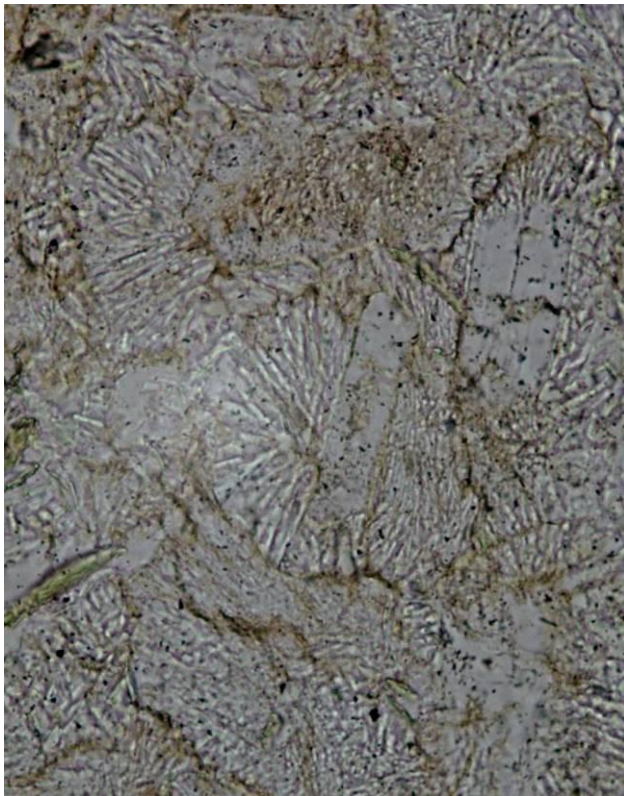
Obr. 108 Sférolitický ortoklas v matrixu ryolitu, skupina „vějířků“ má stejný střed, ze kterého vyrůstají zárodky. Vzorek 01 při zvětšení 200x a světle xpl. (BnČ)
