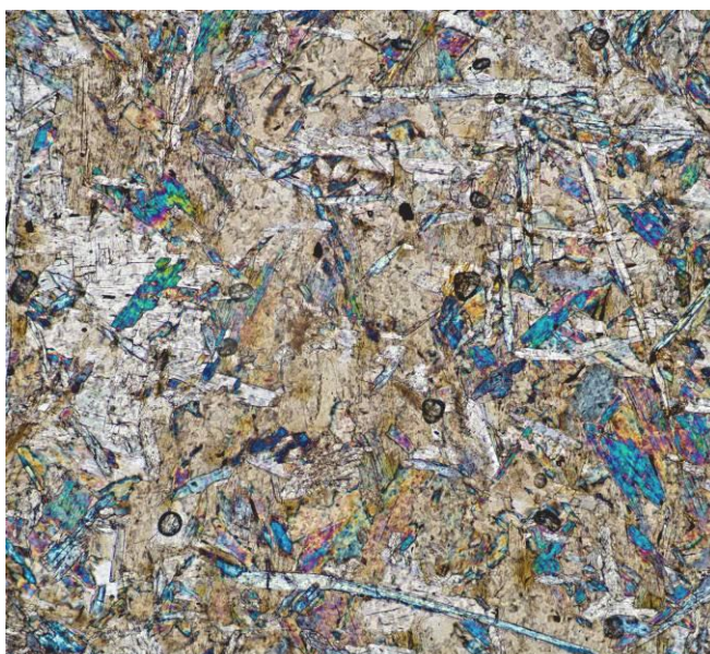
Obr. 151 Vnitřní stavba uzavřeniny, tvořená lupínky muskovitu v porfyru z Malenic. Vzorek C při zvětšení 100x a světle ppl.
