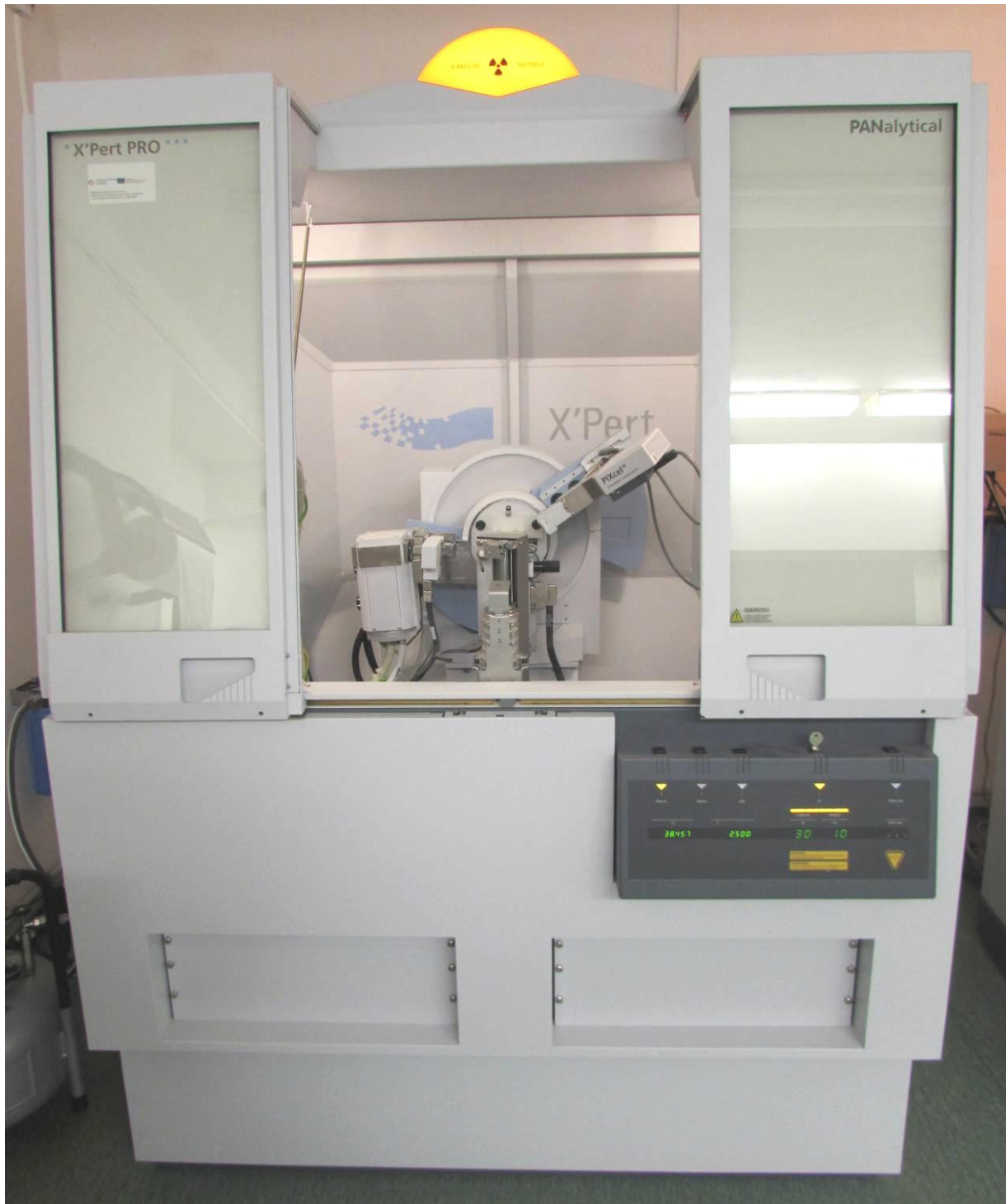
Obr. 70 Rentgenový difraktometr PANalytical X'Pert Pro
