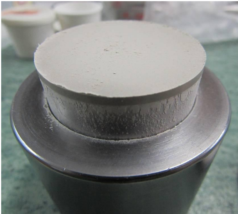
Obr. 60 Výsledek je vylisovaná tableta „voskovka“, která se může vložit do rentgenového spektrometru, kde se jeden vzorek měří po dobu 20 minut
