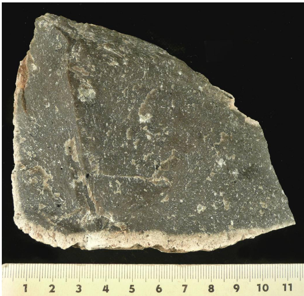
Obr. 81 Sklovitý porfyr z Benešova nad Černou obsahuje silné kaolinické navětrání na svrchní straně (světlý pás podél okraje). Vzorek 03.
