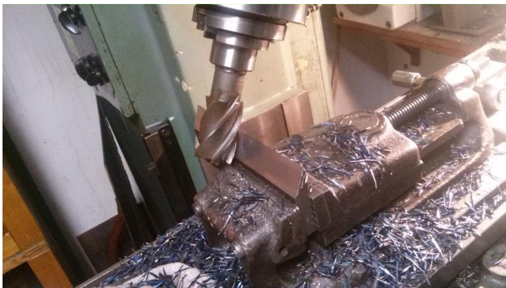
Obr. 21 Frézování vedlejšího ostří nožů
