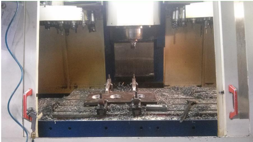
Obr. 23 Frézování spojovací desky
