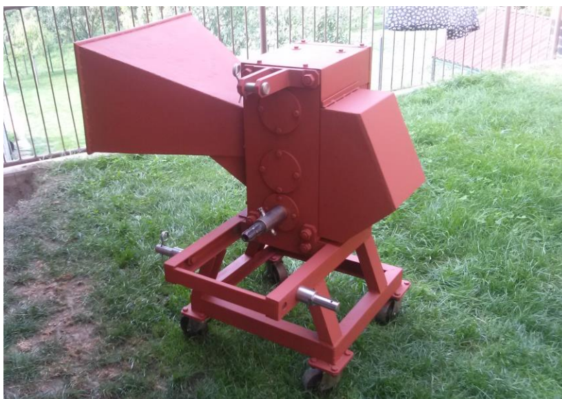
Obr. 32 Kompletně sestavený špalíkovač po nátěru základní barvou
