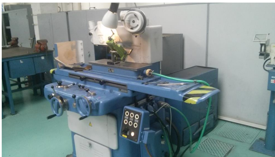
Obr. 22 Broušení hlavního ostří nožů
