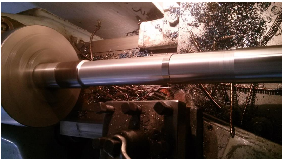
Obr. 25 Soustružení náhonové hřídele
