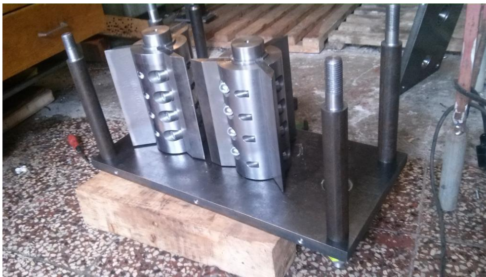
Obr. 29 Částečně sestavená nožová hlava
