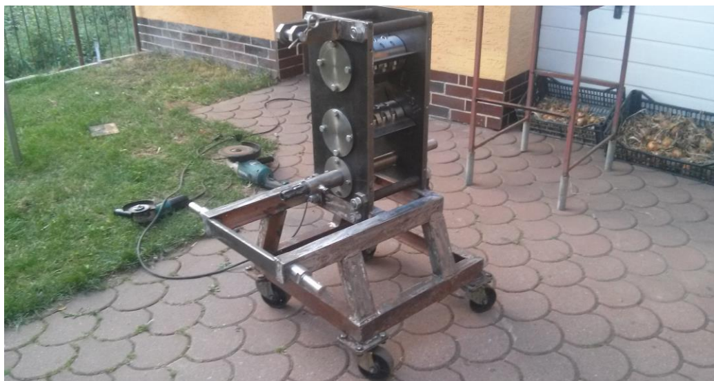
Obr. 30 Sestavená nožová hlava osazená na nosném rámu
