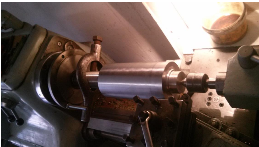
Obr. 19 Soustružení hřídelí mezi hroty
