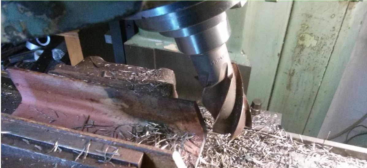
Obr. 27 Frézování úkosů U profilů pro nosný rám
