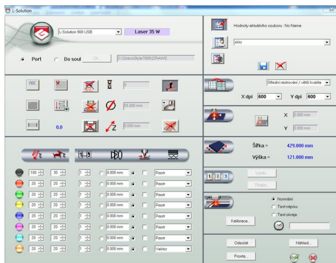
Obr. 13 Nastavení gravírovacího laseru v programu GravoStyle
