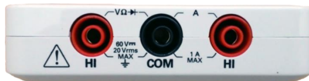
Obr. 2.7 Zdířky pro připojení měřicích sond multimetru
