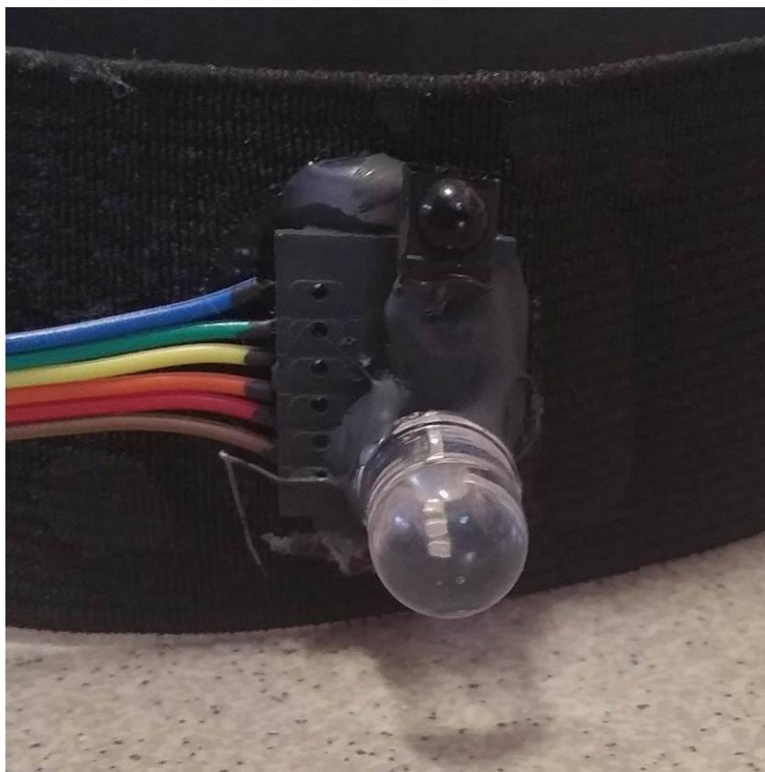
Obrázek 7 - detail sekundární desky pro příjem IR signálu
