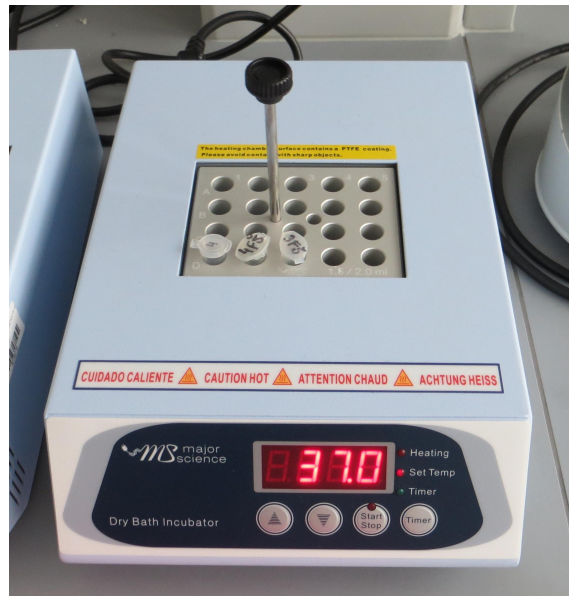
Obrázek 14: Thermoblok. Na tomto zařízení byly inkubovány vzorky za zvýšené teploty. Zdroj: Martin Mátl
