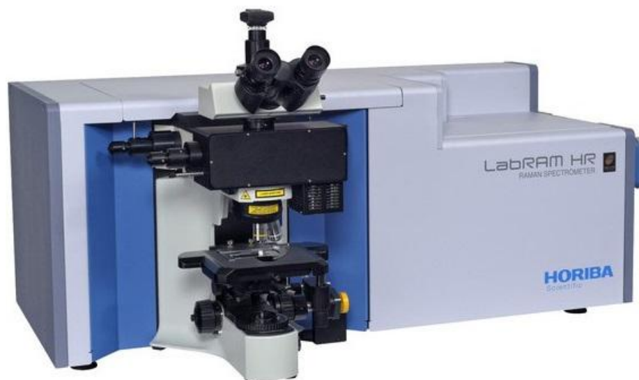
Obrázek 2: Laboratorní přístroj HORIBA LabRam HR Evolution Raman Microspectrometer 2
