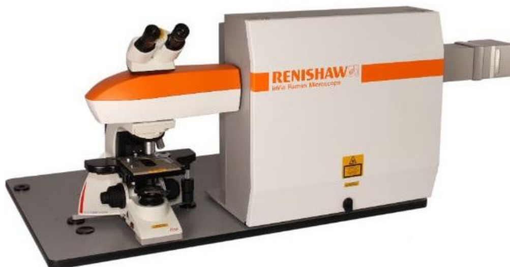
Obrázek 1: Laboratorní přístroj Renishaw InVia Raman Microscope 1
