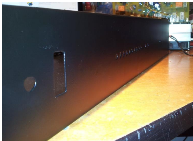
Obrázek 61- Opravená skříň-přední panel
