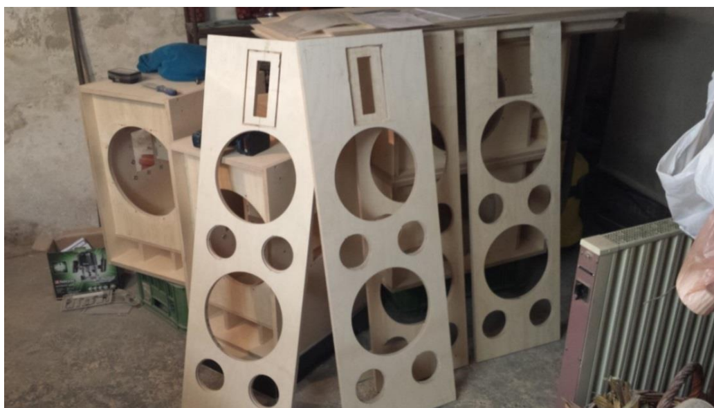
Obrázek 67- Vyfrézované otvory v čelních deskách
