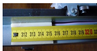
Obr. 8: Vedení kabelu svinovacím metrem
