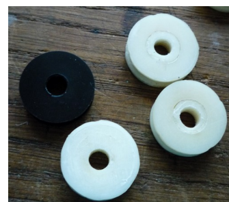
Obr. 9: Soustružená kladka a kladky vytisknuté
