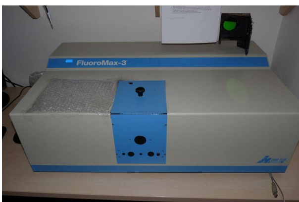
Obr. 16 – přístroj na měření emisních a excitačních spekter (FluoroMax-3). Zdroj: vlastní foto
