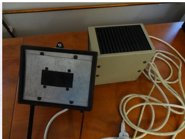
Obr. 13 – UV lampa (transformátor a výbojka). Zdroj: vlastní foto
