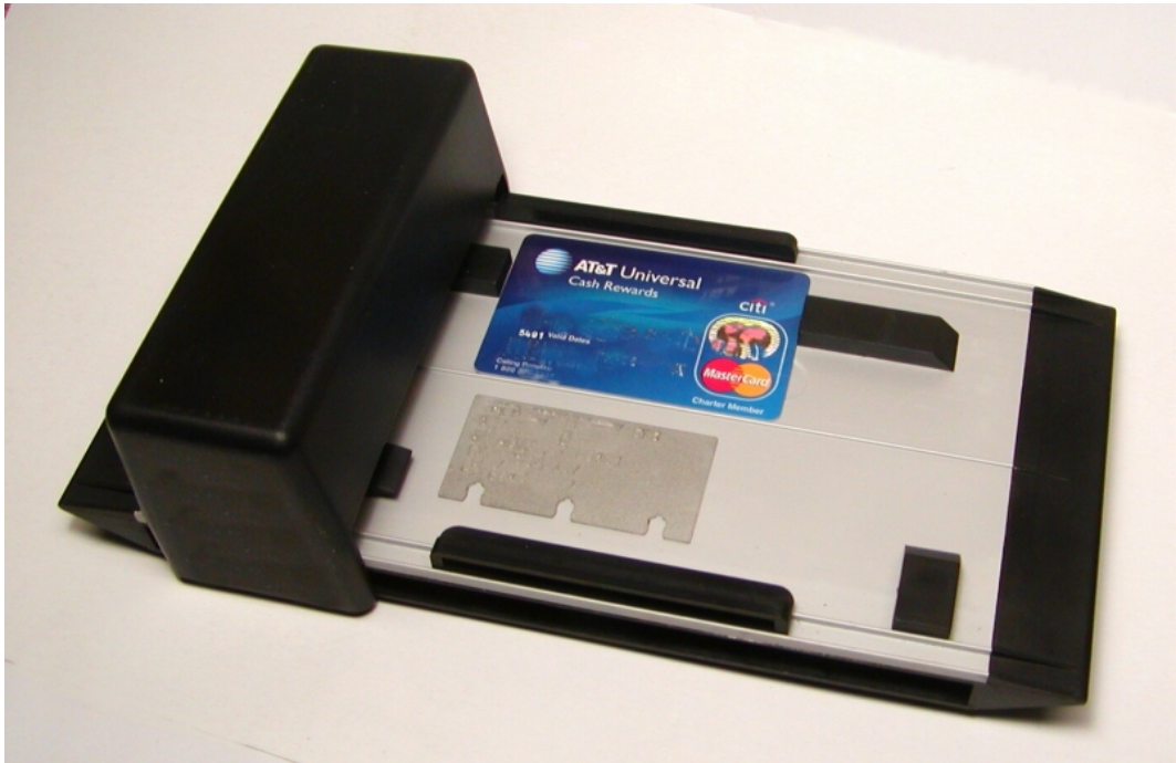
obrázek 27 - imprinter s embosovaným štítkem s informacemi o obchodníkovi a s umístěnou embosovanou platební kartou
