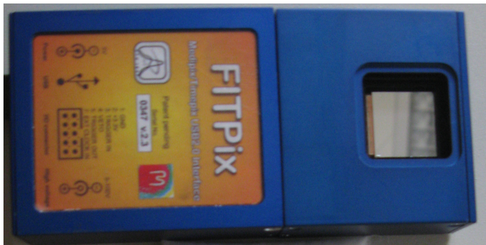
Obrázek 2.5: Námi používaný detektor Timepix z rodiny Medipix spolu s rozhraním FITPix.
