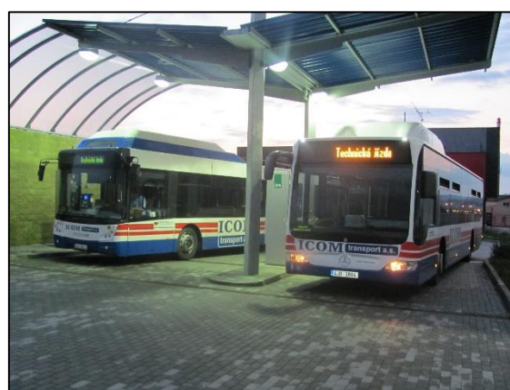
Obr. 7.4 Autobusy Tedom C 12 G a Mercedes-Benz Citaro CNG na stlačený zemní plyn v areálu čerpací stanice poblíž firmy TEDOM
