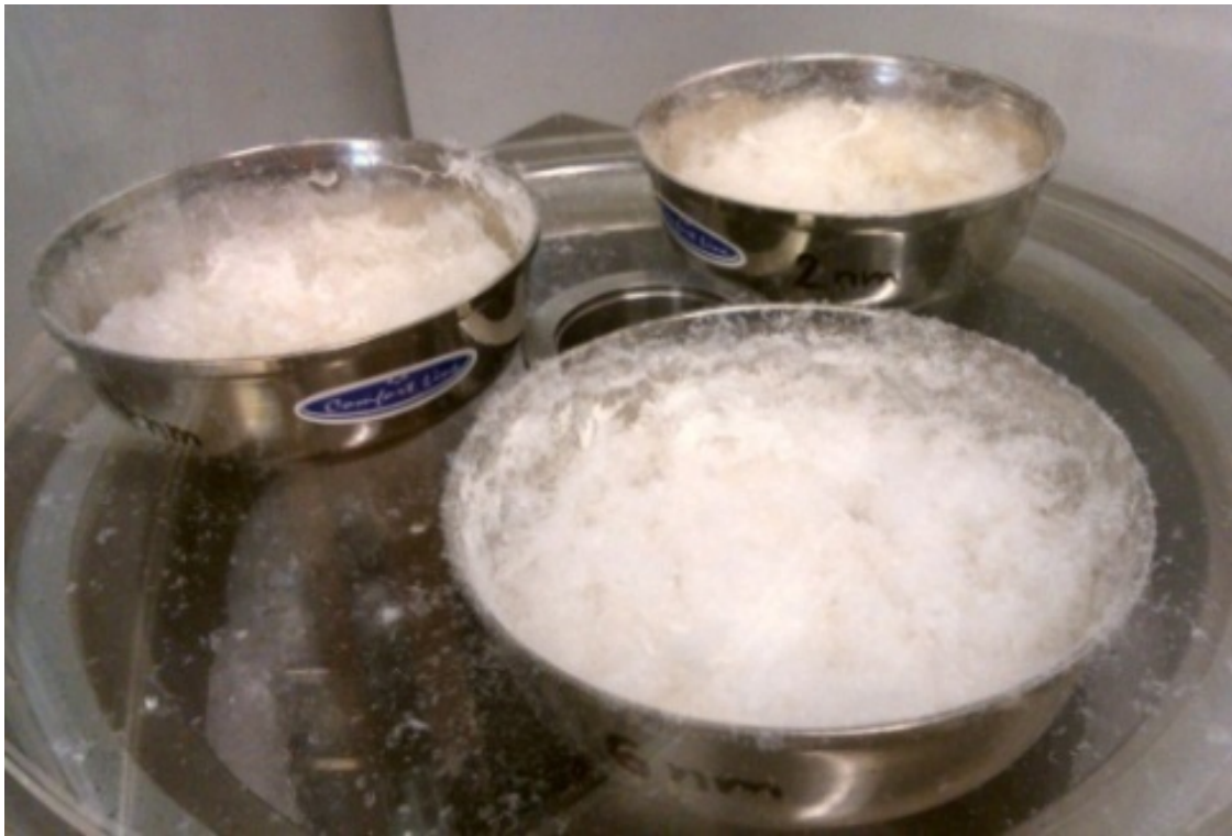
Obrázek 4: Po lyofilizaci - na snímku lze vidět odlišnost vzorků pro různé vrstvy výsledného obalu (vzadu 2 nm, vlevo 4 nm, vpravo 6 nm)
