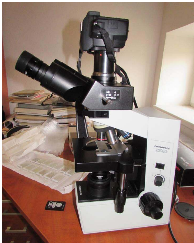
Obr. 31 Olympus CX40, biologický mikroskop v Jihočeském muzeu s nástavcem na fotoaparát, zrcadlovka Olympus E-500 s dálkovým infračerveným ovládáním (dole před mikroskopem).
