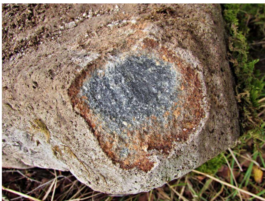
Obr. 7 Kaolinické navětrání povrchu sklovitého porfyru, způsobuje zvýšenou měkkost povrchu oproti vnitřku vzorku
