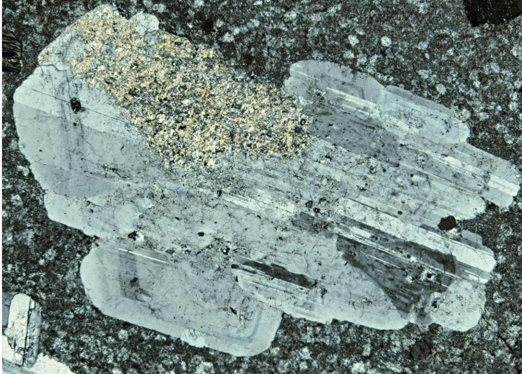
Obr. 71 Kaolinické navětrání na srostlici krytalů plagioklasu, ve vzorku B9 při zvětšení 50x.
