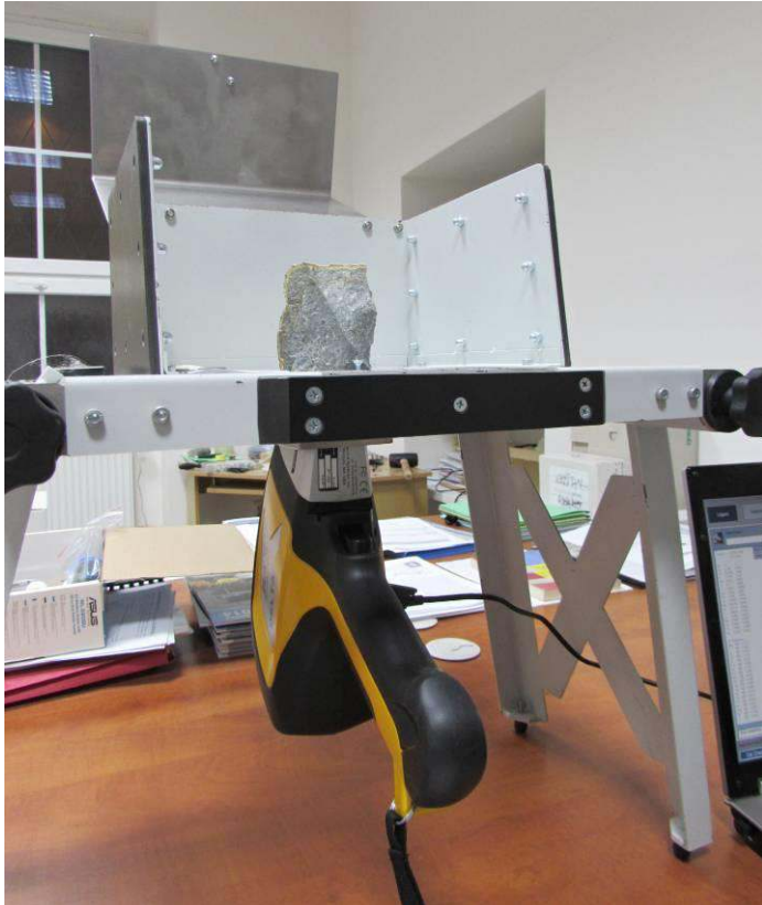
Obr. 32 Přístroj Delta s fixačním stolečkem a se vzorkem C6
