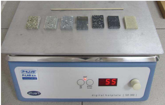
Obr. 19 Vybroušené kostky se nahřejí na temperované plotýnce při teplotě 50 – 60°C, teplota nesmí být příliš vysoká, aby nedošlo k poškození minerálů
