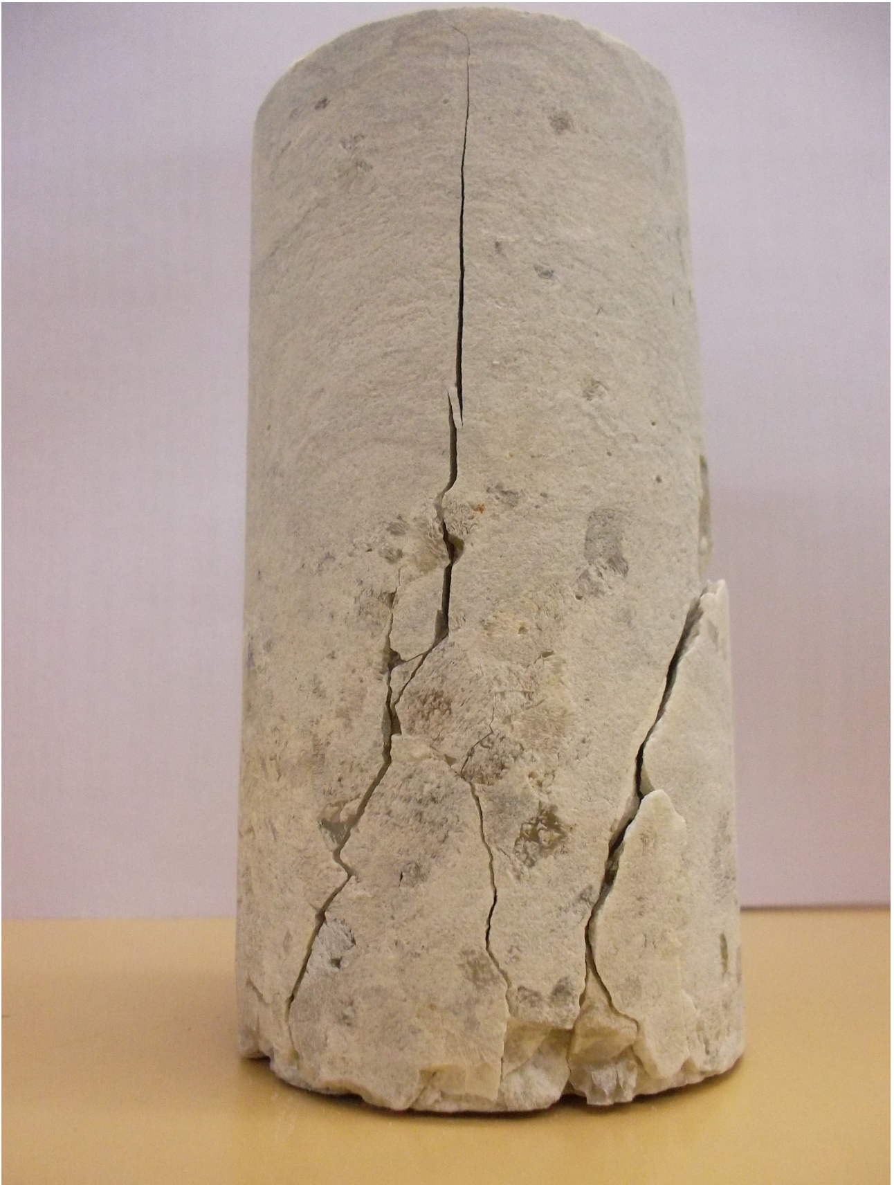
Obrázek 7 Silně poškozený vzorek sádrovce z lokality Kobeřice
