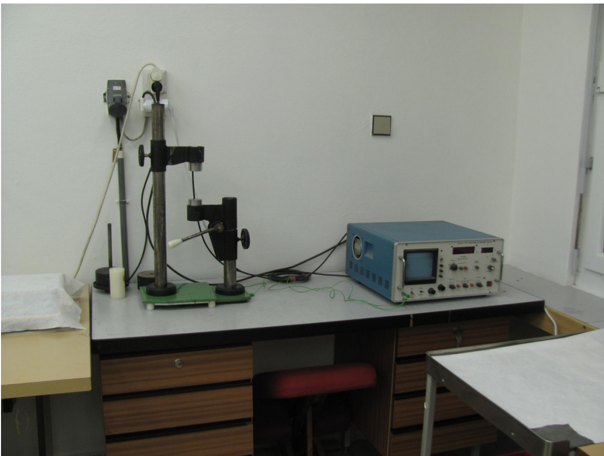
Obrázek 11 Zařízení pro měření rychlosti průchodu ultrazvukových vln
