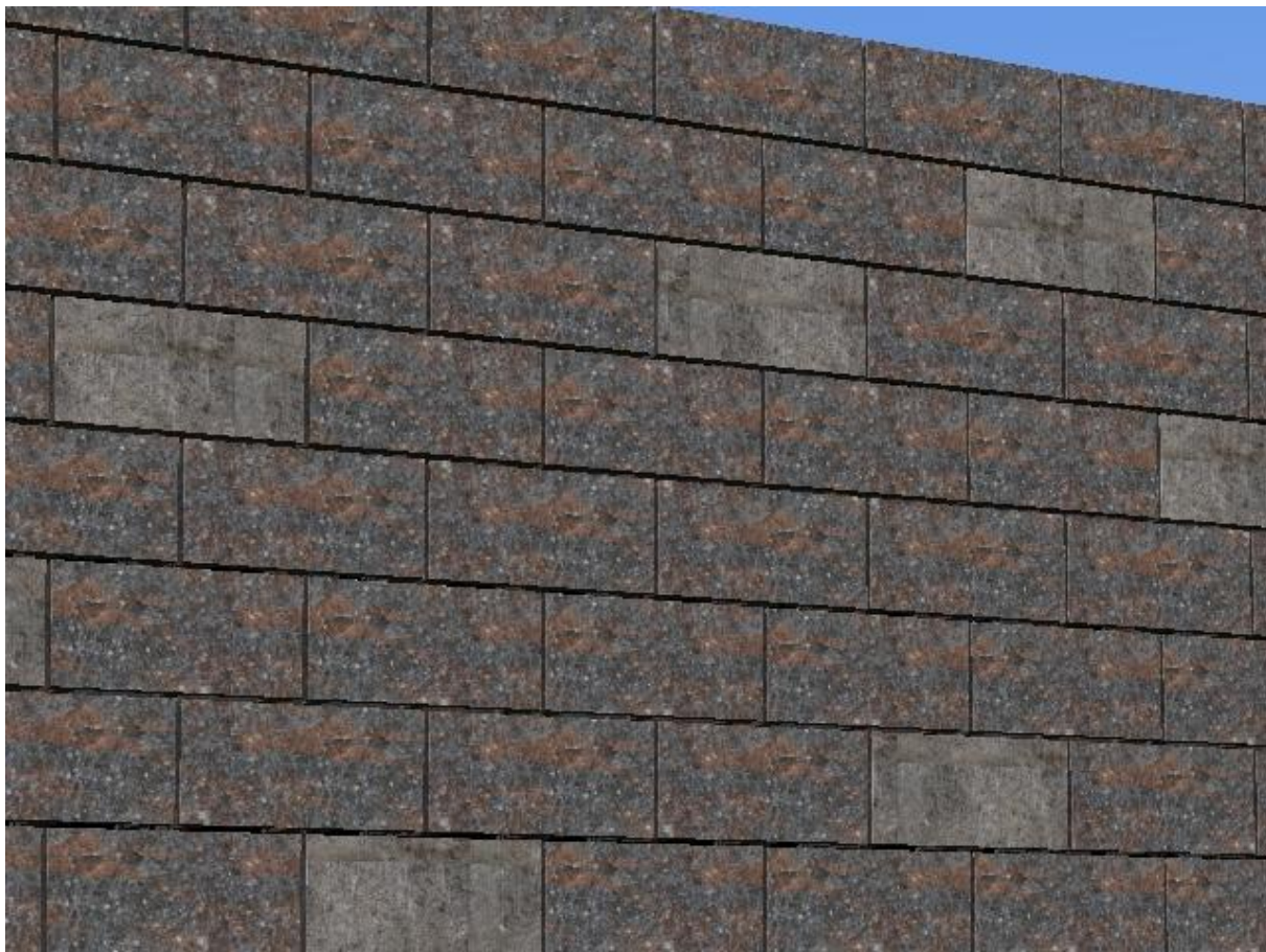
Obrázek 4.1.4.1 – tvárnice KB-BLOK – štípané, prokládané hladkými
