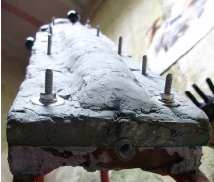
Obr. 74 Připojení vtokové soustavy
