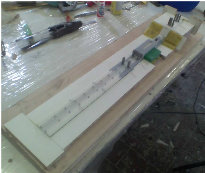
Obr. 59 Zaformování hlavního dílu
