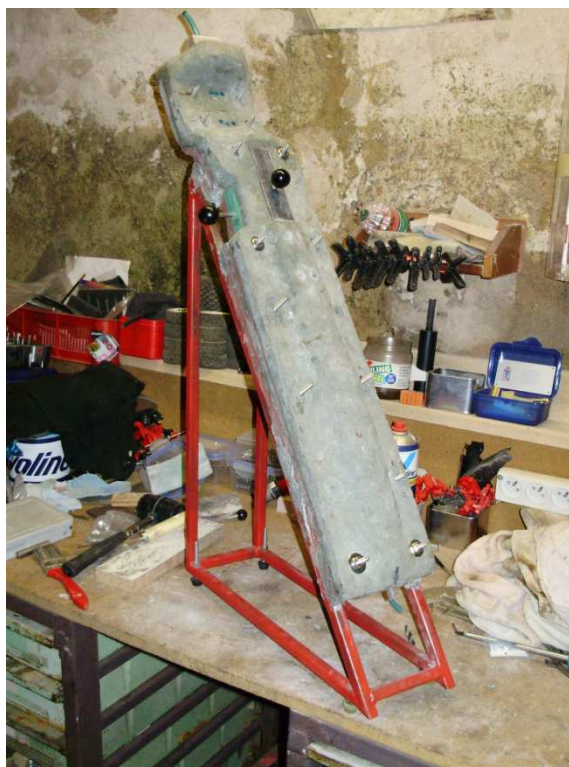
Obr. 52 Složená forma s rámem
