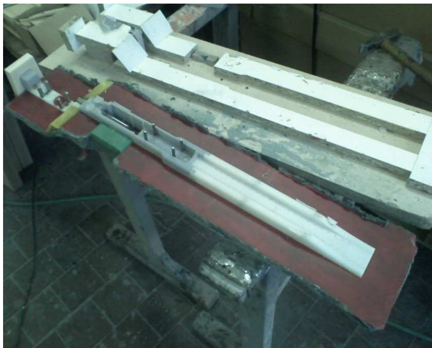
Obr. 62 Rozloupnutí první půlky formy
