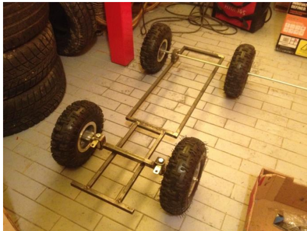
Obr. 16 Základní obrys konstrukce
