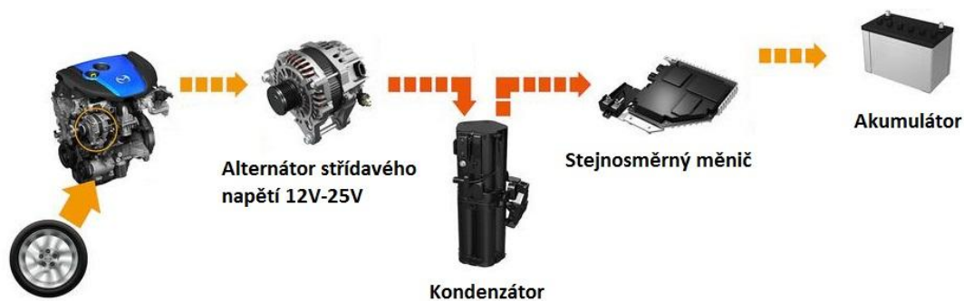
Obr. 12 Rekuperativní systém i-ELOOP
