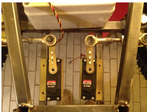
Obr. 21 Nevyhovující koncept nezávislého řízení
