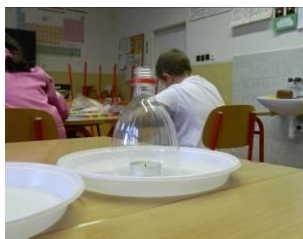
Obrázek 4: Svíčka přiklopená kusem PET lahve na talířku s vodou
