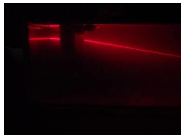
Obrázek 40: Lámání paprsku přes rozptylku
