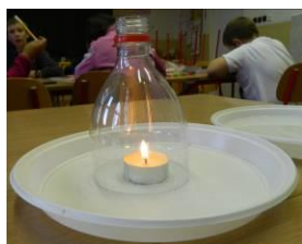
Obrázek 3: Svíčka přiklopená kusem PET lahve na talířku bez vody
