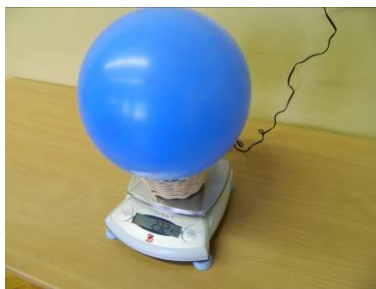
Obrázek 1: Vážení balónku se vzduchem
