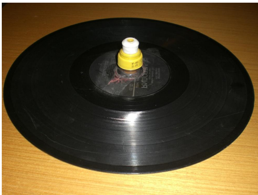
Obrázek 16: Prototyp vznášedla z LP desky
