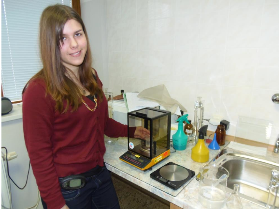
Fotografie 5: Přesnost vah Salter (černý přístroj vpravo) jsem ověřila srovnávacím stanovením navážek na analytických vahách Sartorius v Centru laboratorní medicíny BioLab spol. s r. o. Klatovy. (autor fotografie: Mgr. Evžen Mazánek)
