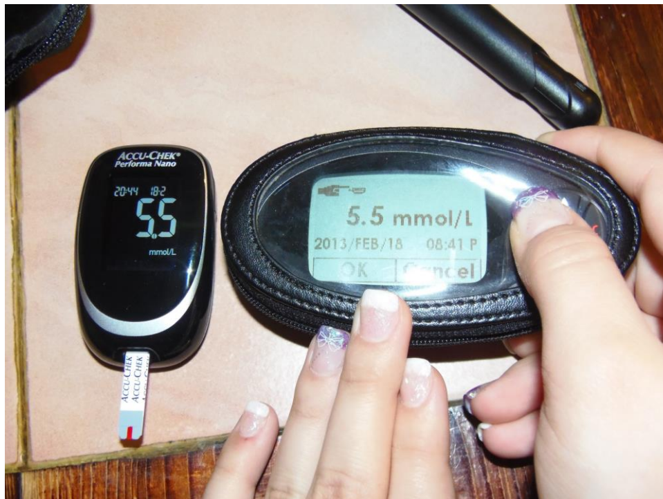
Fotografie 4: Koncentrace glukózy zachycené glukometrem Accu-Chek®Performa Nano jsem využívala pro kalibraci CGMS. (autor fotografie: Mgr. Evžen Mazánek)
