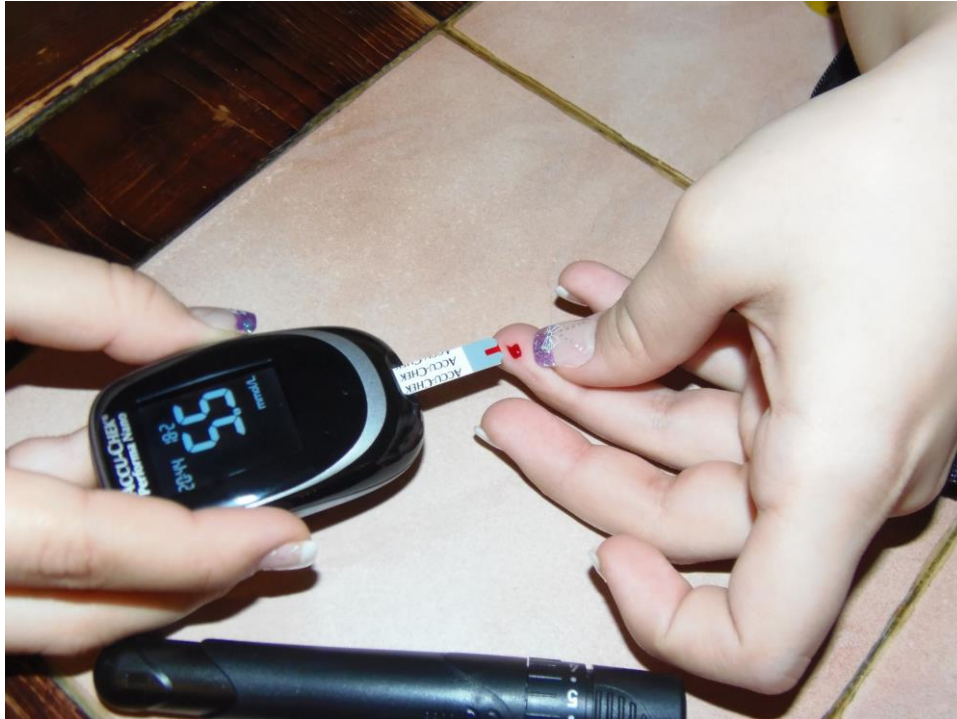
Fotografie 3: Praktická ukázka měření koncentrace glukózy pomocí glukometru Accu-Chek® Performa Nano. Na spodní části fotografie je vidět i tzv. lancetové pero usnadňující odběr kapilární krve. (autor fotografie: Mgr. Evžen Mazánek)
