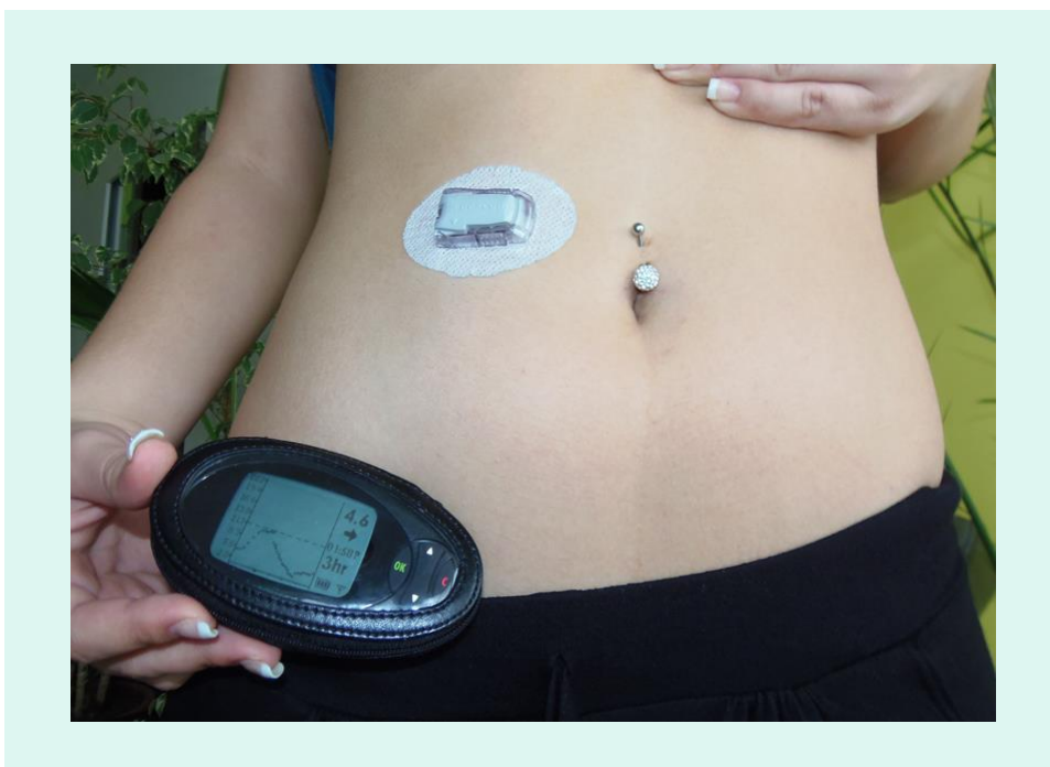
Fotografie 2: Transmitter připevněný na sondu aplikovanou v podkoží v oblasti břicha, v levé ruce držím monitor systému CGM. (autor fotografie: Mgr. Evžen Mazánek)
