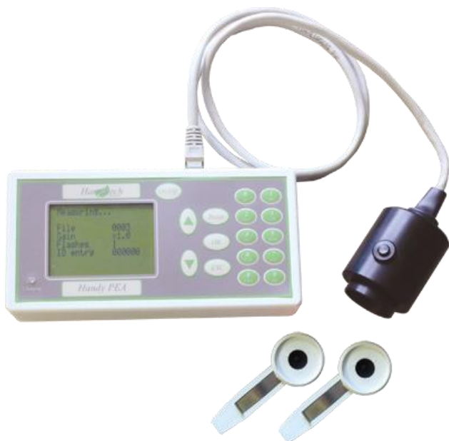
Obr. 6 Pohled na horní část přístroje s displejem a ovládacími tlačítky, napravo odstupuje kabel s detekční částí. Pod přístrojem jsou umístěné 2 klipy. [F]
