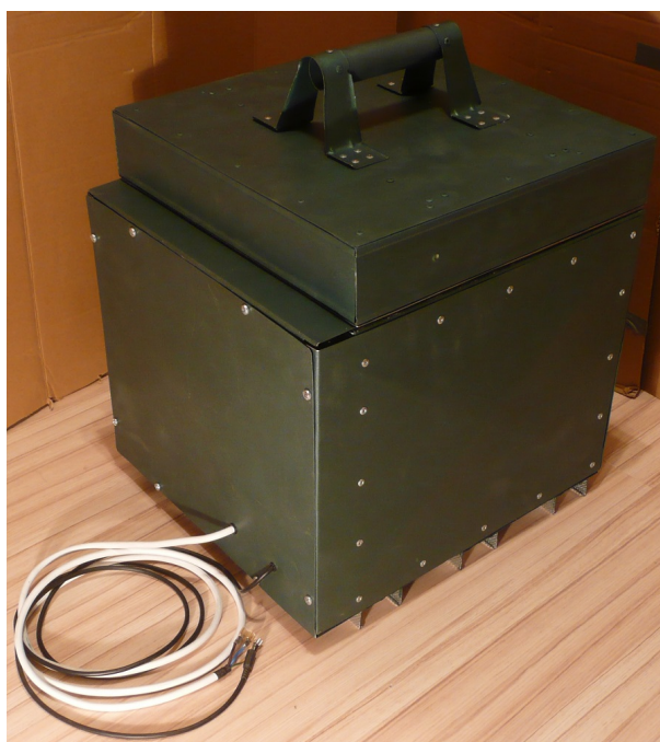
Obr.7.2: Sestavené pecní těleso uzavřené víkem.
