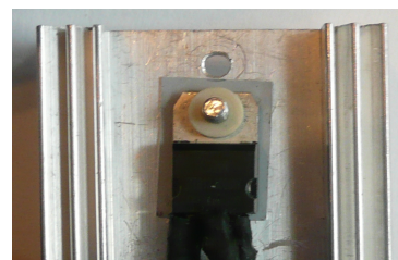
Obr.3.2.3: Triak s izolační podložkou.
