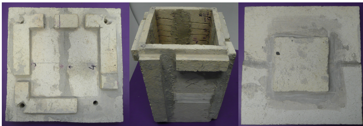
Obr.5.3.2: Fotografie vyrobených šamotových součástí pece.
