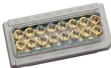
Obrázek 20 16-jamková E-destička určená k real time analýze buněk (41)
