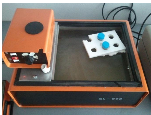
Obrázek 12 – Ošetřování suspenze ve vodní lázni; foto D. Štípl
