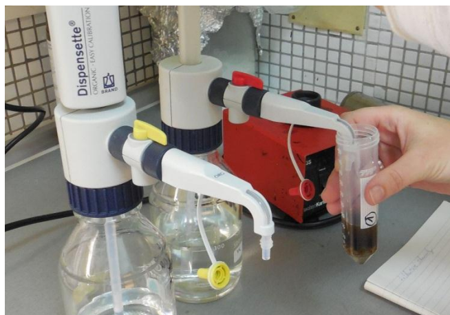
Obrázek 10 – Přidávání vody a toluenu pomocí pipetmanu; foto V. Křišťůfek
