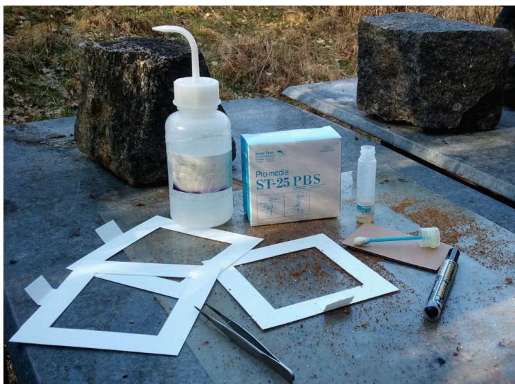
Obrázek 26 – Kompletní příslušenství potřebné k odběru vzorků na včelnici (plastový rámeček, tuba s 5% roztokem Tweenu 80, pinzeta, fix, plastový rámeček, stříčka s etanolem a papírové utěrky); foto D. Štipl
