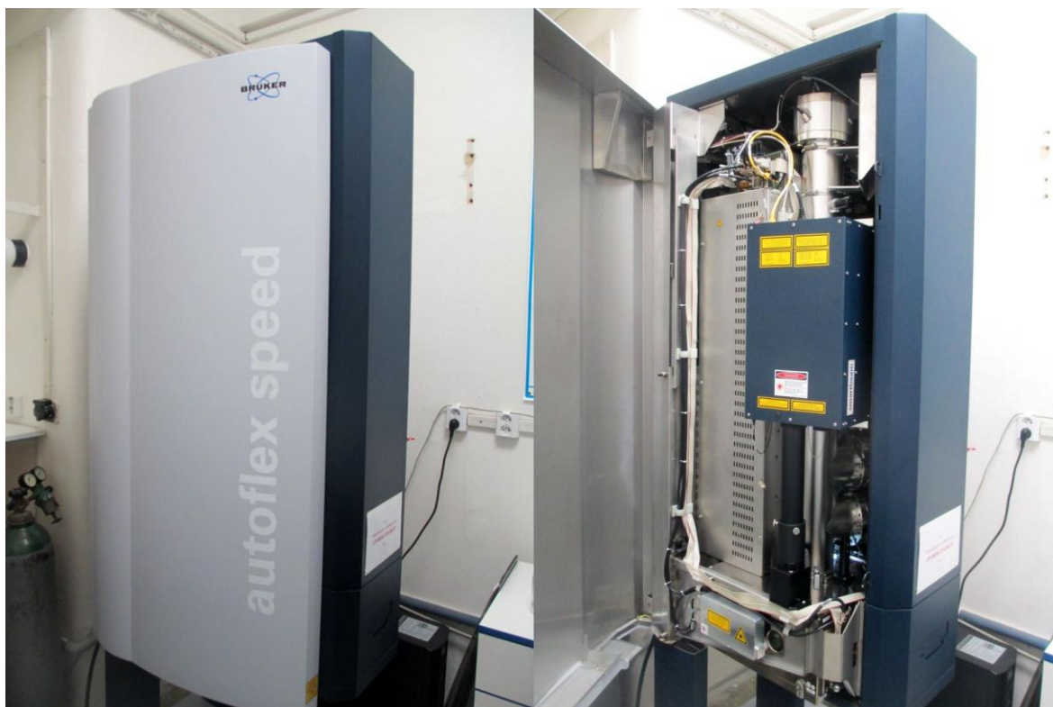
Obrázek 6 – Příklad přístroje Autoflex speed (vpravo náhled do otevřeného přístroje) pracující na principu MALDI – TOF MS (VŠCHT Praha); foto D. Štipl
